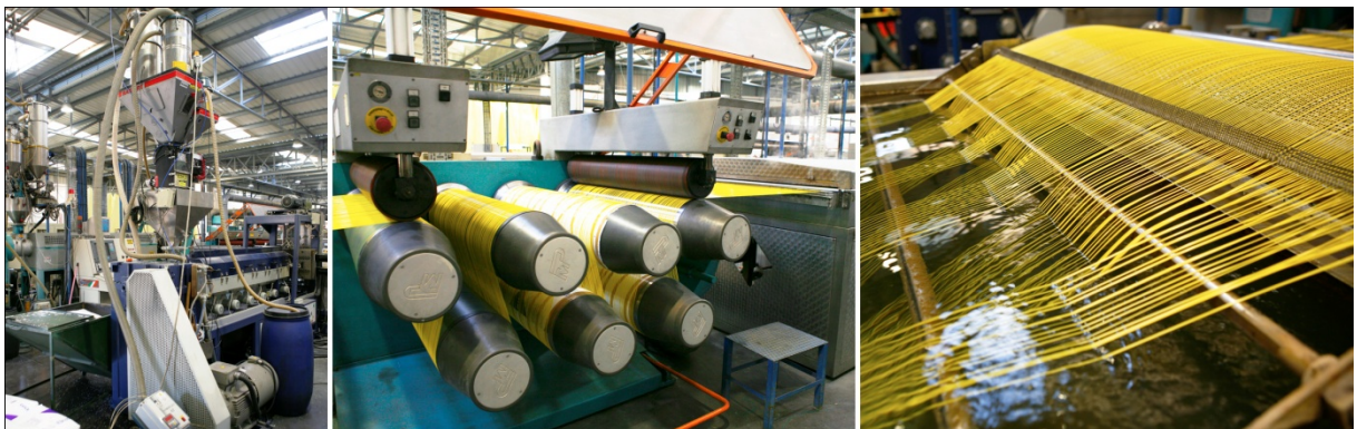
Figura 9 – Máquina extrusora, rolos de estiragem e arrefecimento dos monofilamentos
