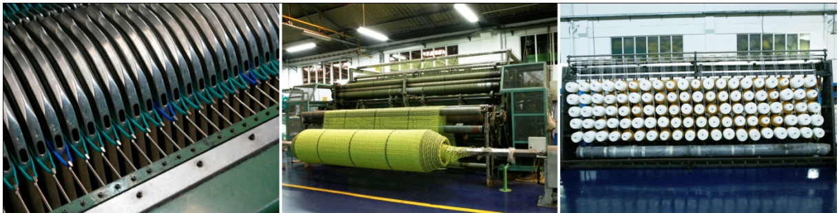
Figura 11 – Agulhas, vista frontal e vista traseira de um tear (estante)
