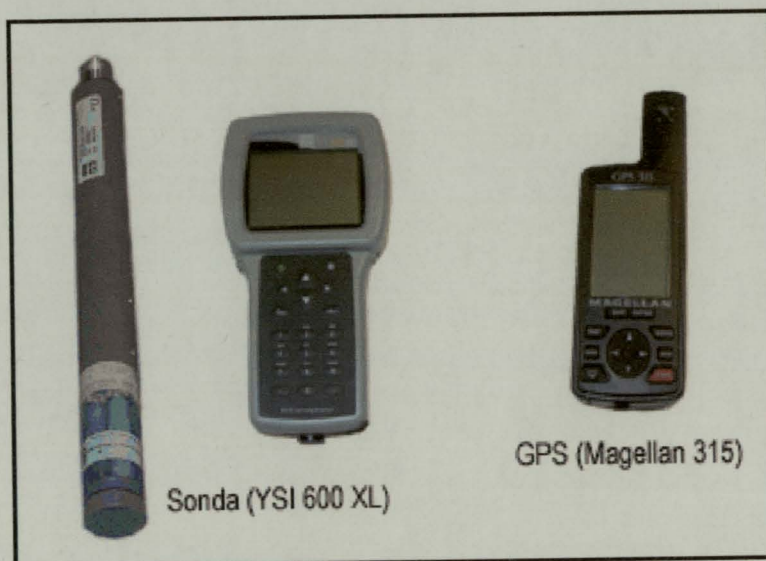
Figura 2 - Sonda multi-parâmetros (YSI 600 XL) e GPS (Magellan 315).
