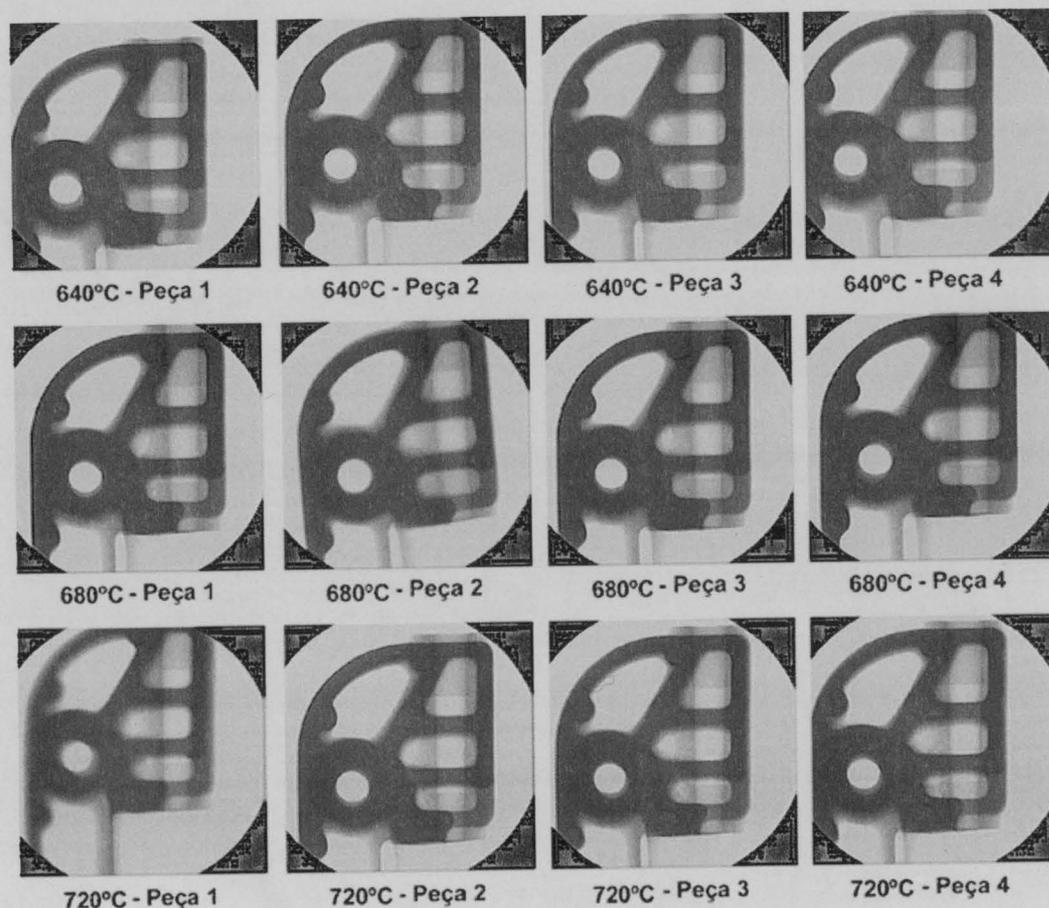
Figura 45 – Raios X das peças injectadas com variação da temperatura da liga
