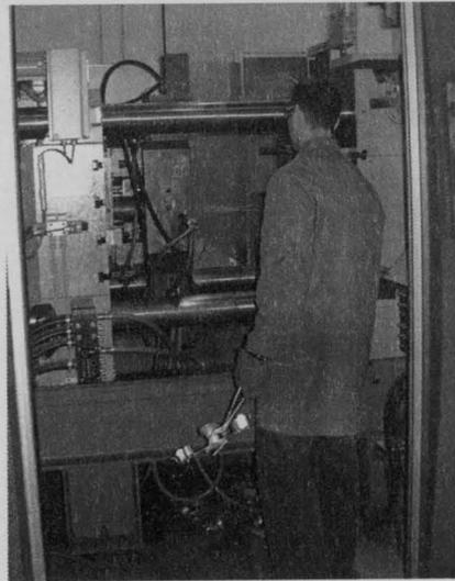
Figura 37 – Lubrificação e extracção manual
