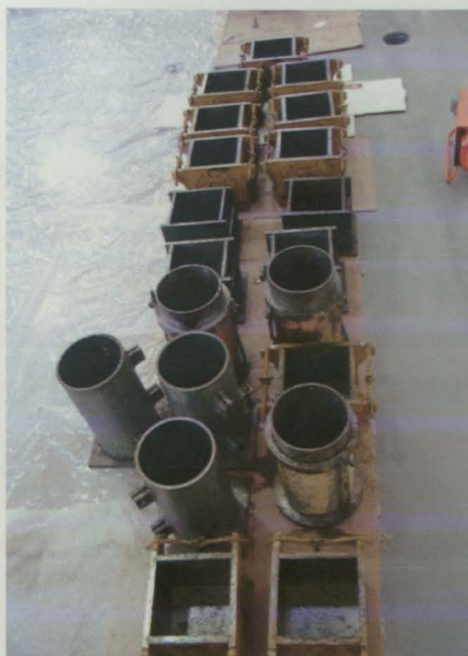
Figura 5 – Moldes cúbicos e cilíndricos
