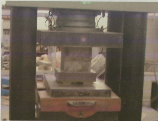
Figura 2 – Ensaio de cubos de betão à compressão
