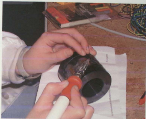
Figura 7 – Célula de carga para registo da força de pré-esforço
