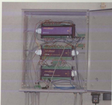
Figura 10 – Sistema de aquisição de leituras (Esq.) e ligação do sistema de aquisição a um computador portátil para "download" de dados
