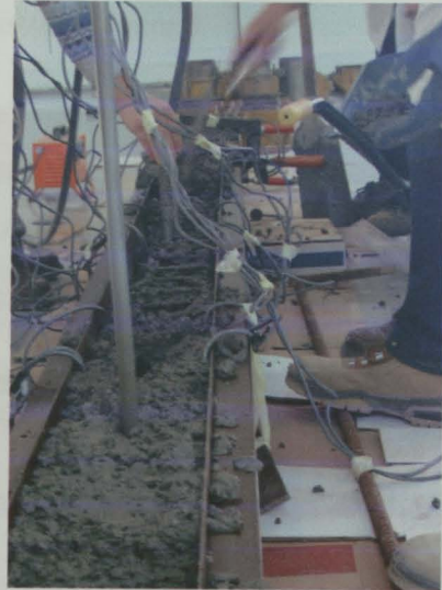
b) Aplicação do betão no molde
