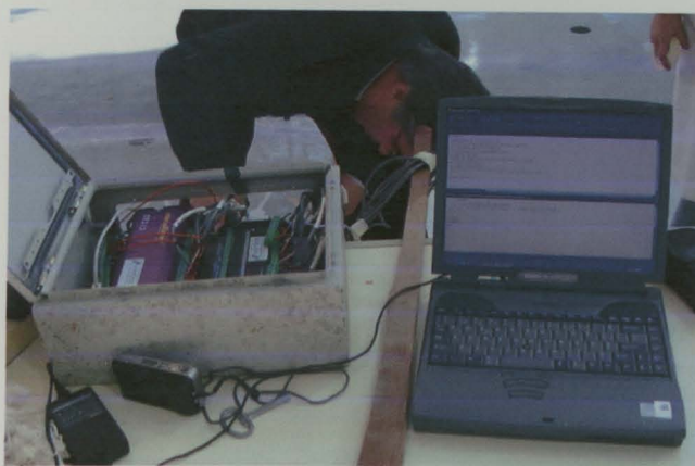
Figura 10 – Sistema de aquisição de leituras (Esq.) e ligação do sistema de aquisição a um computador portátil para "download" de dados
