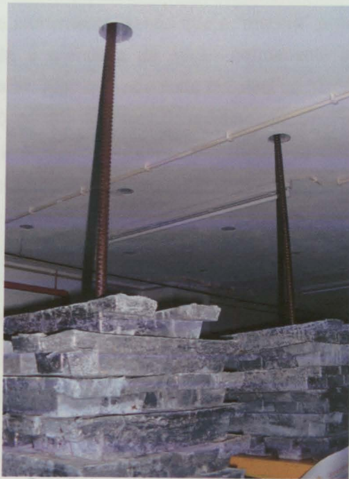
Figura 7 – Acção permanente (lingotes de chumbo)
