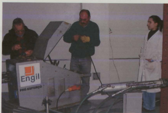
d) Colocação do macaco
