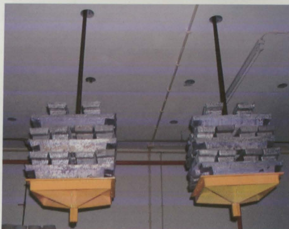
Figura 8 – Sistema usado para materialização da acção permanente
