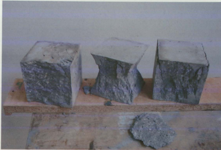
Figura 3 – Provetes após ensaio à compressão
