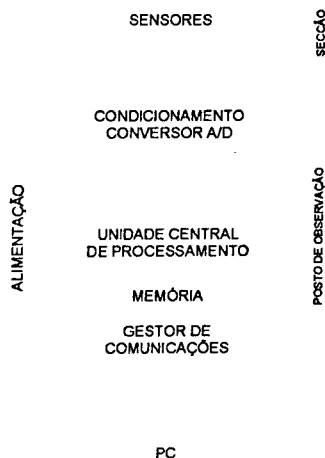
Figura 1 – Esquema geral do sistema de monitorização utilizado
