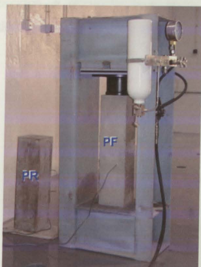
Figura 1 – Prismas compensadores de retracção (esq.) e de fluência (dir.)
