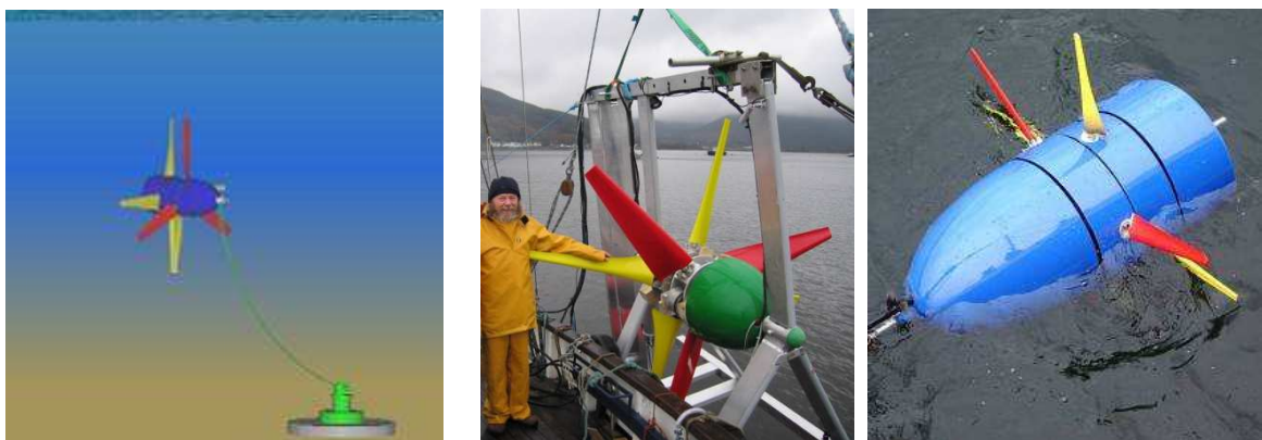
Fig.3.33 – À esquerda: Representação do sistema CoRMaT; No centro: Modelo à escala 1/10 para teste do rotor; À direita: Modelo à escala 1/10 de análise do comportamento geral do sistema, [85].
