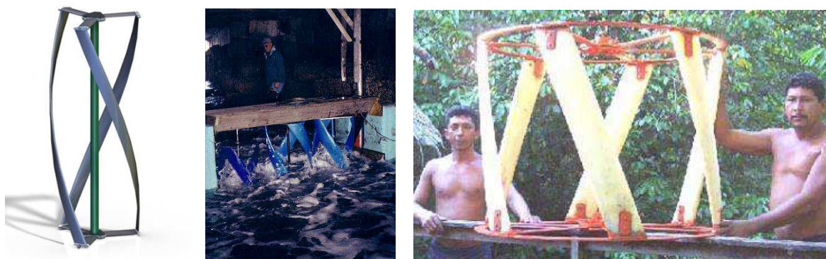
Fig.3.20 – À esquerda: Representação da Gorlov Helical Turbine , [63]; No centro: Instalação de teste em Vinalhaven Island, EUA, 2003; À direita: Aplicação da turbina helicoidal na ilha de Combu, Brasil, 2002, [66].
