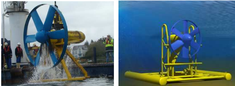
Fig.3.18 – À esquerda: Protótipo Sabella D03 ; À direita: Representação do Sabella D10 , [60].
