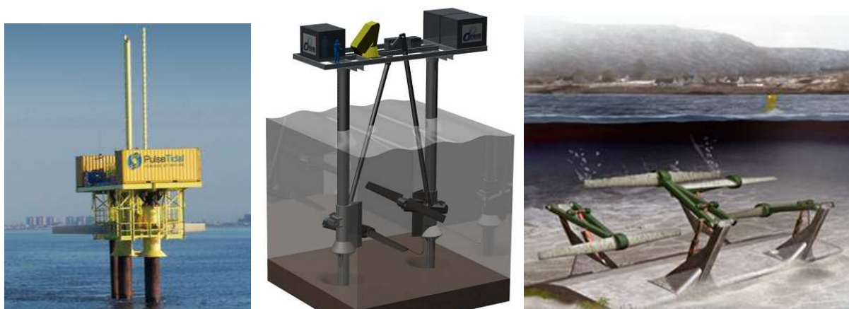
Fig.3.27 – À esquerda e no centro: Sistema PS100 , [75]; À direita: Representação do sistema comercial com 1MW de potência.
