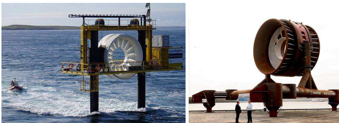
Fig.3.2 – À esquerda: Protótipo com uma potência de 250kW instalado no EMEC, [35]; À direita: Sistema comercial da Open Hyro , Canadá, [36].
