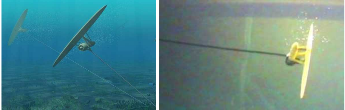
Fig.3.32 – À esquerda: Representação do sistema Deep Green; À direita: Fotografia dos testes realizados com um protótipo deste sistema no laboratório do “Maritime Research Institute Netherlands”, [84].
