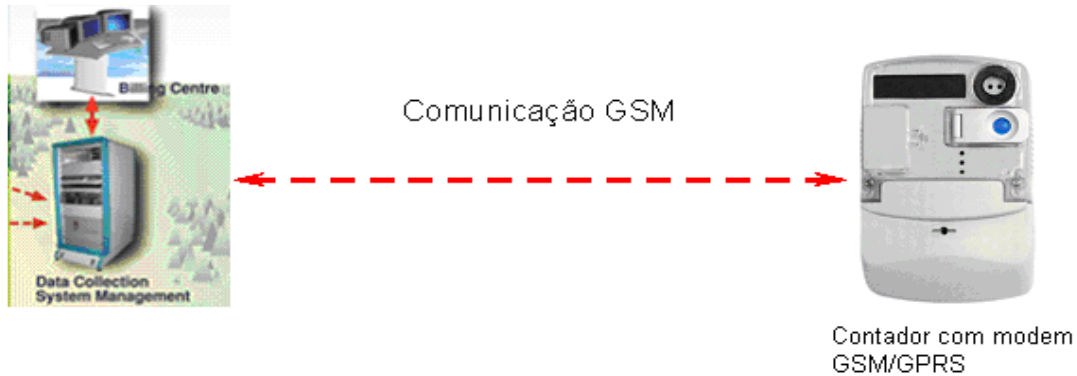
Figura 3.6 – Comunicação GSM entre o sistema central e o contador do tipo Mx372 [34].
