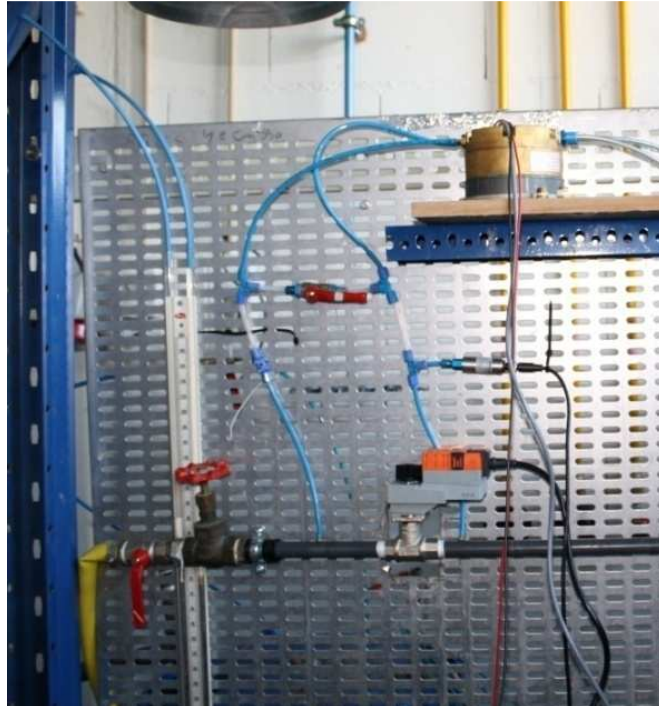
Figura 31 – Foto tirada na banca de ensaios. No cima da imagem é possível ver o transdutor de pressão diferencial. Do lado esquerdo, o manómetro de mercúrio em U. Entre a válvula testada e o transdutor de pressão diferencial encontra-se o transdutor de pressão que media a pressão a montante da válvula de teste. Na medição das diferenças de pressão, intercalou-se uma válvula estabilizadora entre as duas tomadas de pressão.
