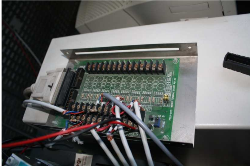
Figura 33 – Foto da placa terminal PCLD-8115 da Advantech. Foram adquiridas as tensões geradas pelo transdutor de pressão 1, transdutor de pressão diferencial 2, transmissor de caudal tipo turbina 4, posicionador do actuador da válvula de controlo 6.
