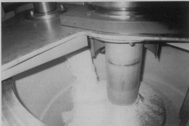
**Figura 14:** Inicio do descarregamento do açúcar afinado.
