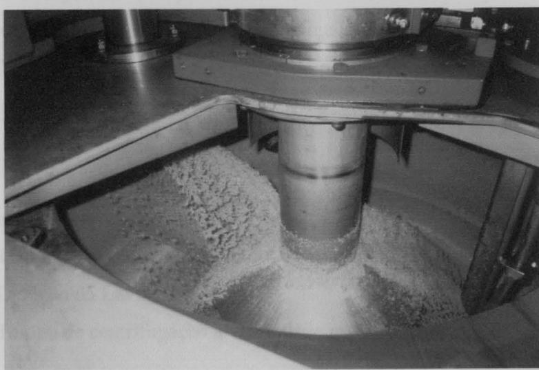
**Figura 15:** Descarregamento do açúcar afinado.
