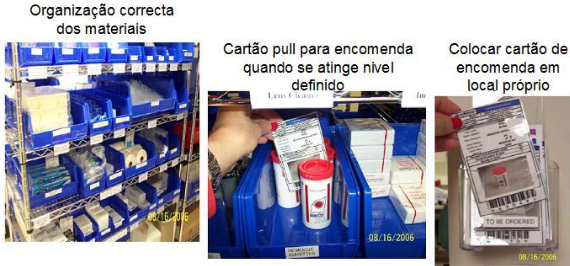
Figura 9 – sistema kanban para gestão do abastecimento normalizado
