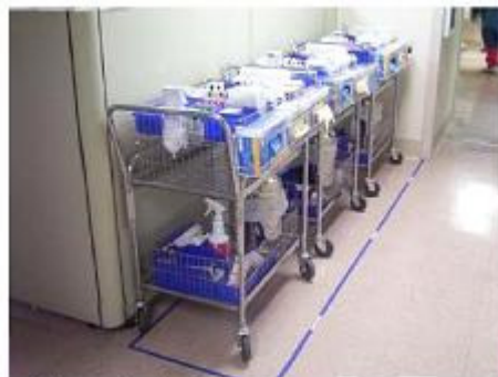
Figura 9 – sistema kanban para gestão do abastecimento normalizado
