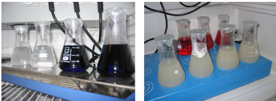
Figura 6.7 Ensaios para determinação da influência do adsorvente na absorvância e no COT
