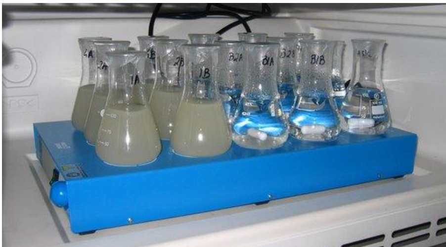
Figura 6.3 Ensaio para determinação do PCPZ pelo método “ batch equilibrium ”
