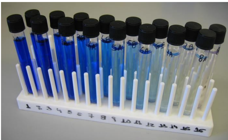
Figura 6.6 Amostras preparadas para leitura de COT
