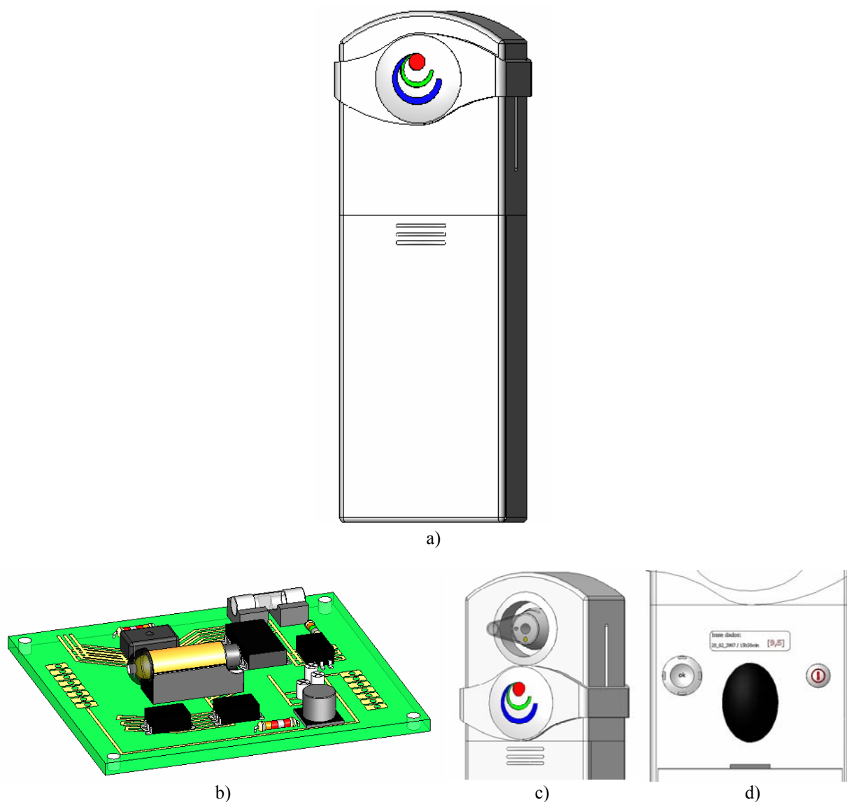
Figura 7.26: Modelo_2 para o otoscópio óptico-electrónico: a) visualização do modelo; b) placa electrónica onde se visualiza a lâmpada de halogéneo; c) espéculo fixo no cone e emissão de luz branca pela fibra óptica; d) elementos de comando e display .
