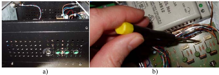
Figura 5.52: Montagem do painel esquerdo (3ª fase): a) pormenor da remoção dos potenciômetros laterais; b) potenciômetros fixos de regulação vertical com acesso controlado.
