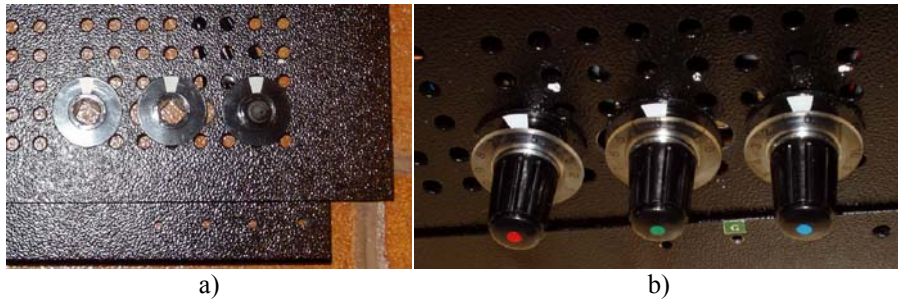
Figura 5.51: Montagem do painel esquerdo (2ª fase): a) furos existentes no painel alargados, e base para o contraste da escala; b) botões dos potenciômetros devidamente identificados pelo círculo de cor em vinil autocolante e munidos de escala indicadora.
