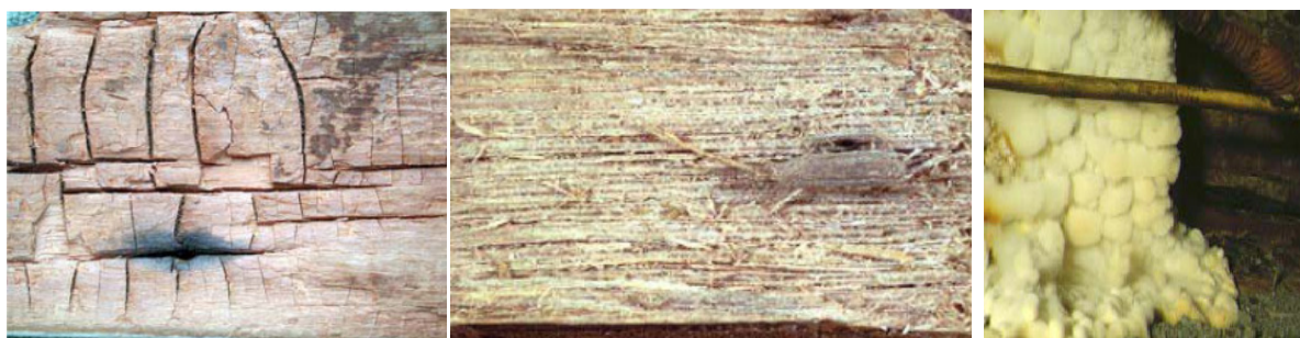
Fig.2.15 – À esquerda é visível a podridão castanha; ao centro a podridão branca ou fibrosa; à direita podridão branda
