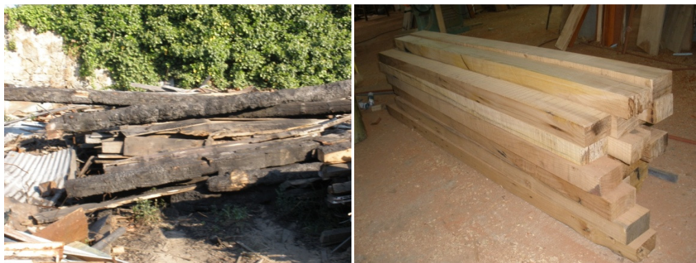
Fig.4.6 – Preparação das amostras “G”. Esquerda: vigas de madeira ardida retiradas do palacete; Direita: aspecto final dos provetes “G”
