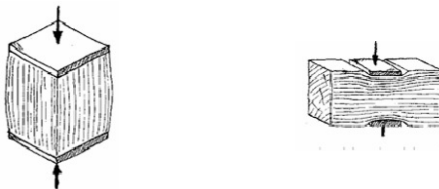
Fig.4.12 – Tipos de ensaios à compressão
