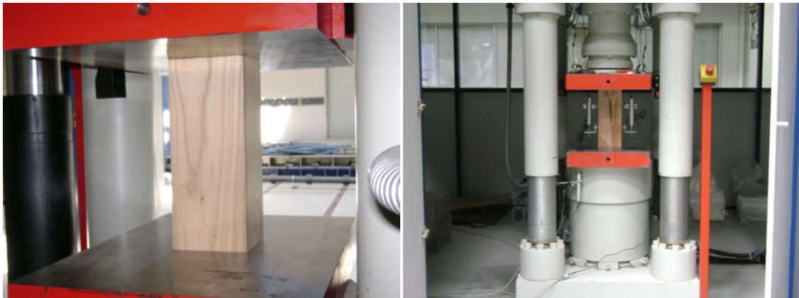
Fig.4.13 – Vistas do ensaio de compressão axial
