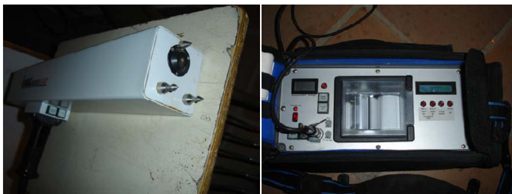
Figura 3.4 – À esquerda ilustra-se o corpo central do Resistograph . À direita é visível a bateria e impressora portátil (Botelho, 2006)
