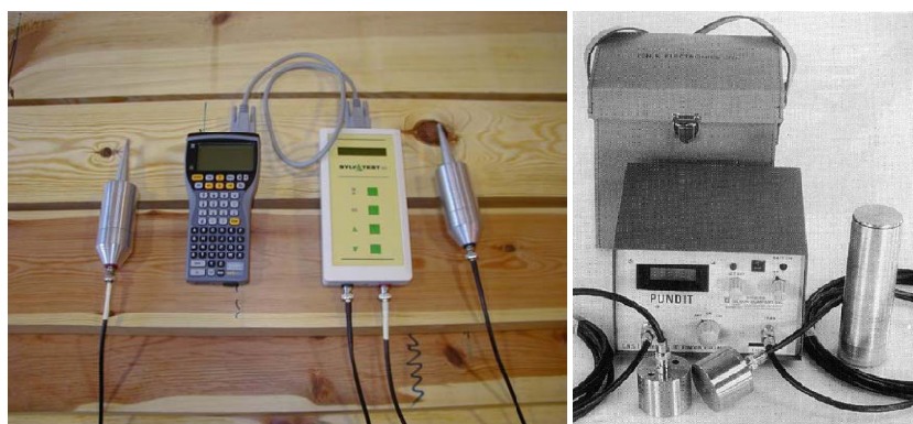
Figura 3.3 – Aparelhos de avaliação não destrutiva por avaliação da velocidade de propagação de ultra-sons: à esquerda aparelhos Sylvatest e à direita exibe-se o PUNDIT (Botelho, 2006).
