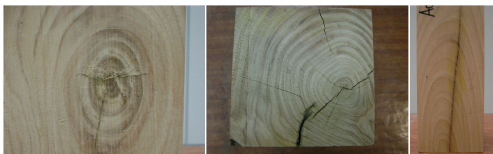
Fig.4.15 – Defeitos registados antes do ensaio
