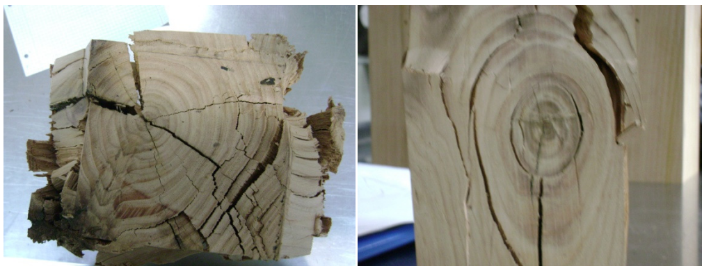
Fig.4.18 – Rotura de uma amostra submetida ao ensaio de compressão axial
