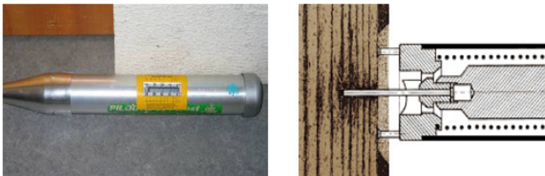
Figura 3.6 – À esquerda mostra-se o Pylodin 6J ; à direita ilustra-se o esquema de funcionamento do Pylodin (Dias, 2008)
