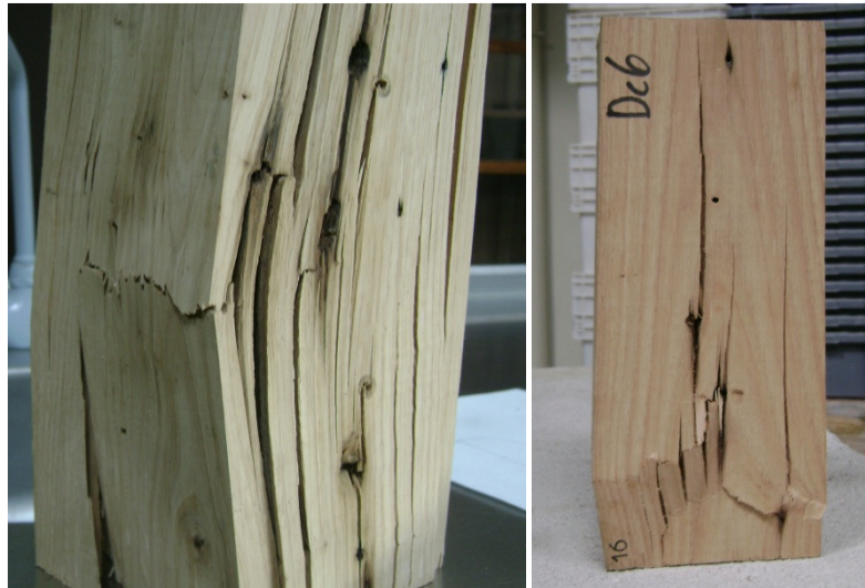
Fig.5.8 – Influência dos furos provocados por pregos nas linhas de rotura
