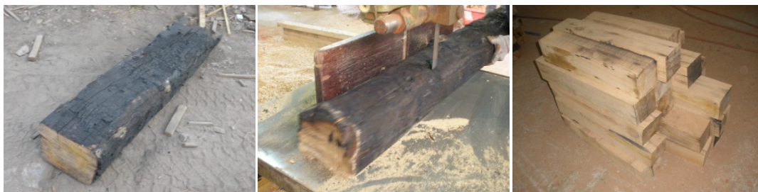
Fig.4.3 – Preparação das amostras “Ac”. Esquerda: viga de madeira de Carvalho ardida; Centro: corte realizado sobre as vigas; Direita: aspecto final dos provetes “Ac”
