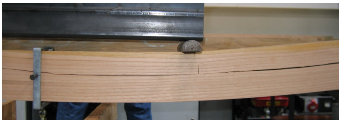
Fig.5.22 – Fissura prolongada ao longo da peça
