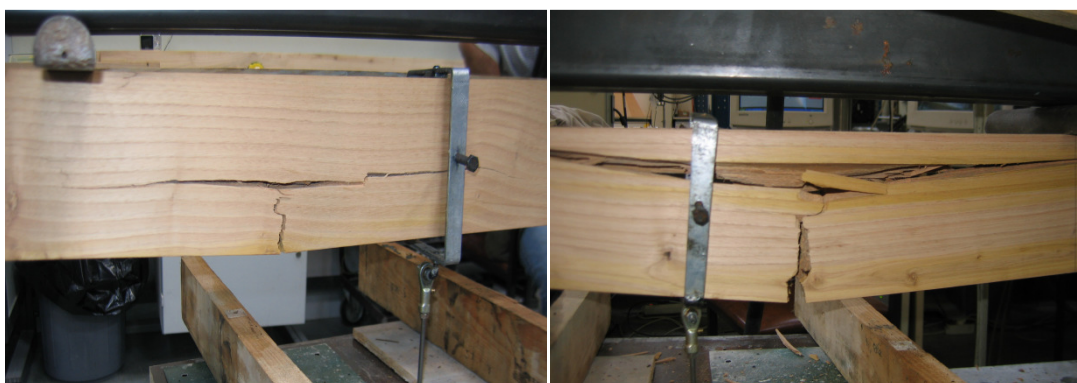
Fig.5.23 – Rompimento na zona traccionada
