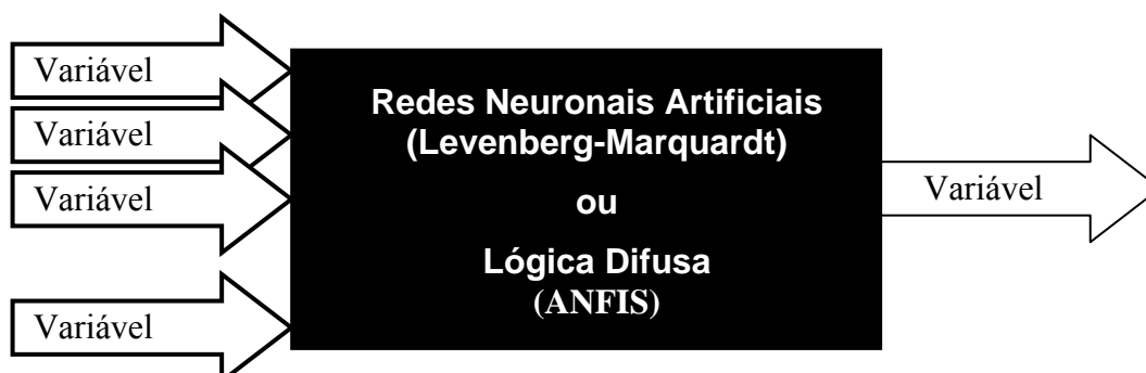
Figura 5. 3 – Arquitectura das ferramentas utilizadas
