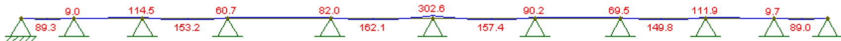
Fig A3. 37- Diagrama de momentos devido à aplicação da carga distribuída, para a secção de momentos negativos, em perfil longitudinal relativa à sobrecarga no parapeito
