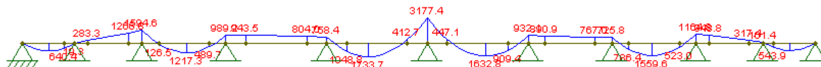
Fig A3. 71 - Diagrama de momentos referente ao vento na direcção z para a maximização dos momentos negativos
