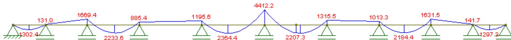
Fig A3. 17- Diagrama de momentos devido à aplicação da carga distribuída, para a secção de momentos negativos, em perfil longitudinal relativas ao LM1
