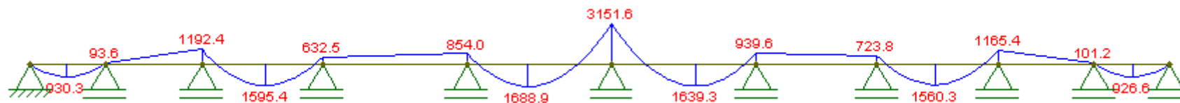
Fig A3. 43- Diagrama de momentos devido à aplicação da carga distribuída, para a secção de momentos negativos, em perfil longitudinal relativa à acção do vento em z
