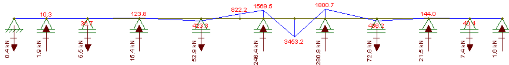
Fig A3. 25- Diagrama de momentos devido à aplicação das cargas concentradas, para a secção de momentos positivos, em perfil longitudinal relativas ao LM2
