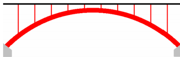
Fig. 2.16– Arco rígido com superestrutura flexível
