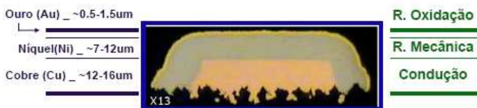
Fig.15 – Contacto eléctrico no substrato, camada metálica e seu revestimento. Espessura de cada uma das camadas e função associada [10].
