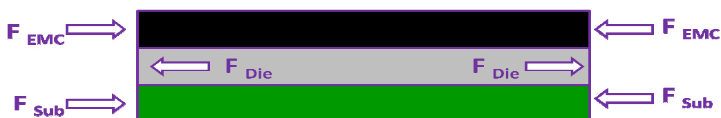
Fig.19 – Esquema de forças representativas da reação do arrefecimento na etapa de Mold [10].
