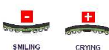
Fig.17 – Caracterização dos empenos pela sua curvatura [15].
