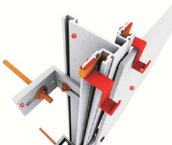
Fig.2.8 – Fixação visível – painéis cerâmicos sobrepostos
