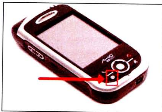
Figura 7 – Botão configurado para acesso rápido ao ecrã de criação de mensagem MMS no smartphone MIO A701
