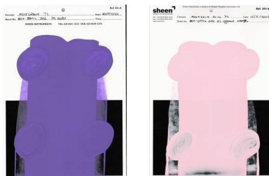
Figura 10 – Resultados obtidos na base transparente da tinta Acriláqua, à esquerda, e na base branca da tinta Argasilk Plus, à direita.
