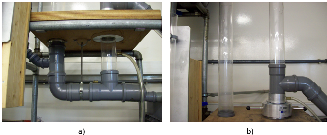
Figura 3.25 - Partes transparentes do circuito: a) Inferior; b) Superior.
