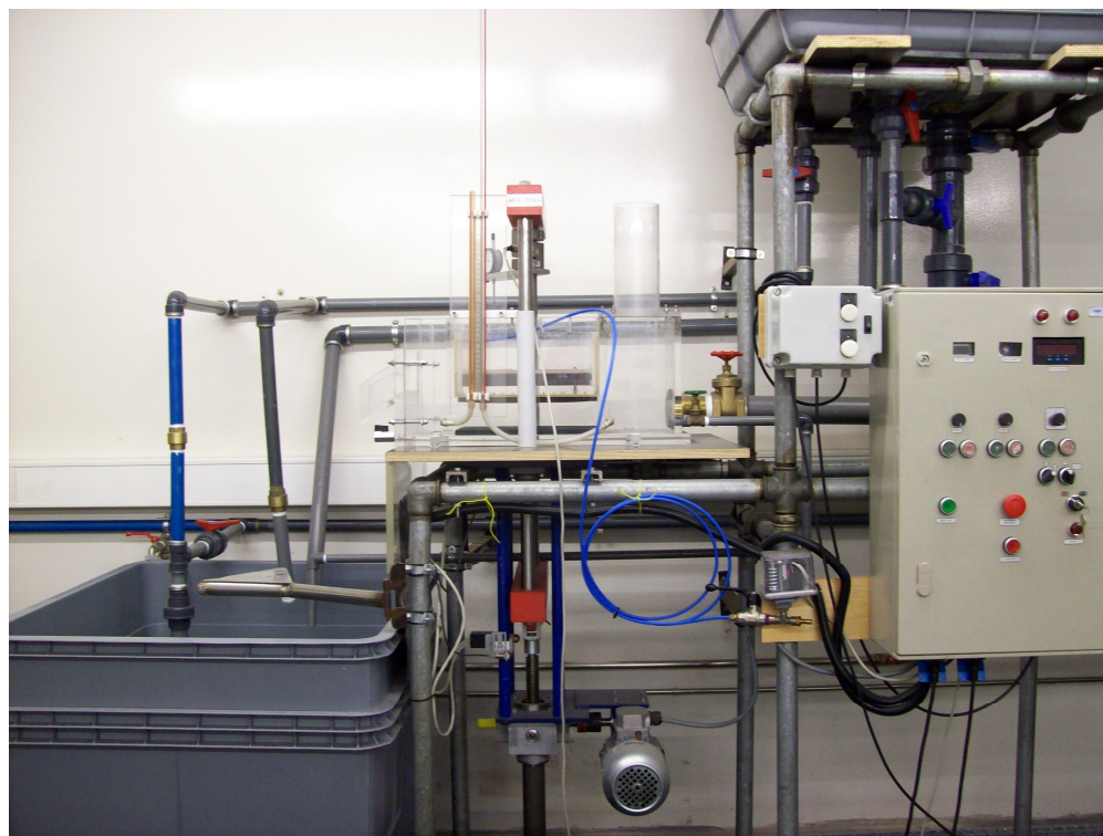
Figura 3.12 - Vista geral do equipamento do LGS, de ensaio da permeabilidade no plano do material.
