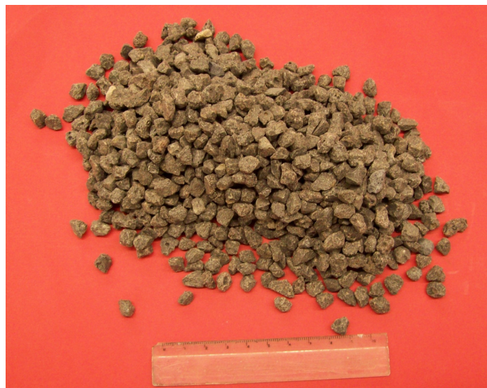
Figura 2.9 - Material granular de confinamento (Corundum).
