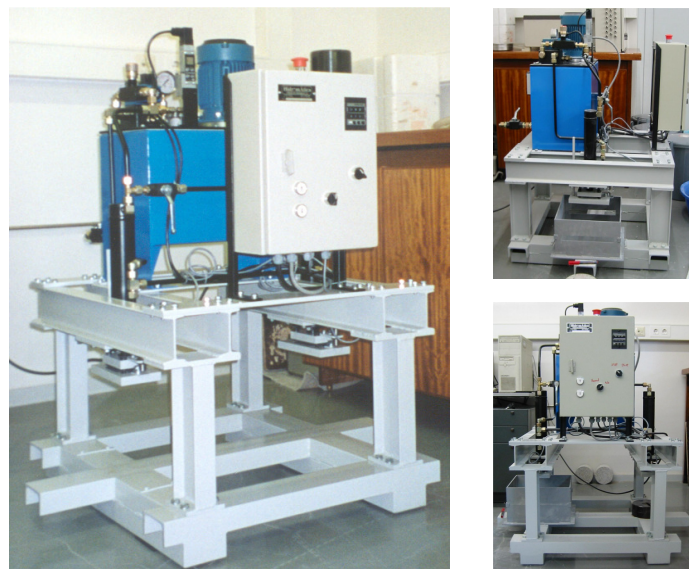
Figura 2.6 - Vista geral do equipamento de danificação de geossintéticos (Paula, 2003).
