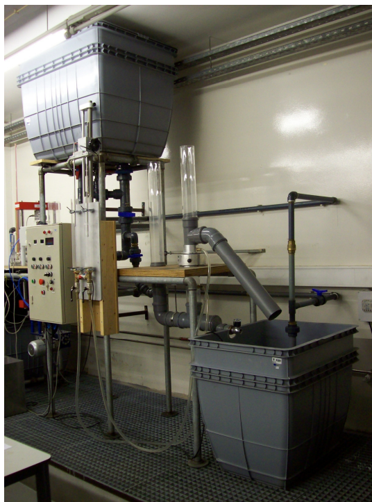
Figura 3.23 - Equipamento de ensaio da permeabilidade normal ao plano do material: vista geral, com os reservatórios superior e inferior.
