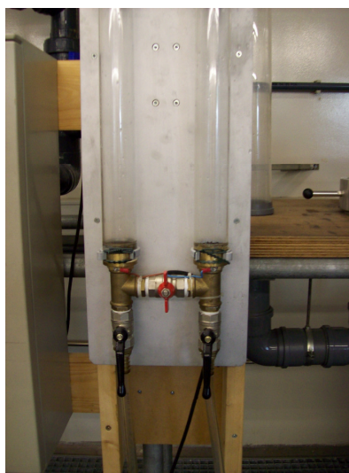
Figura 3.30 - Tubos em acrílico para observação da carga hidráulica.
