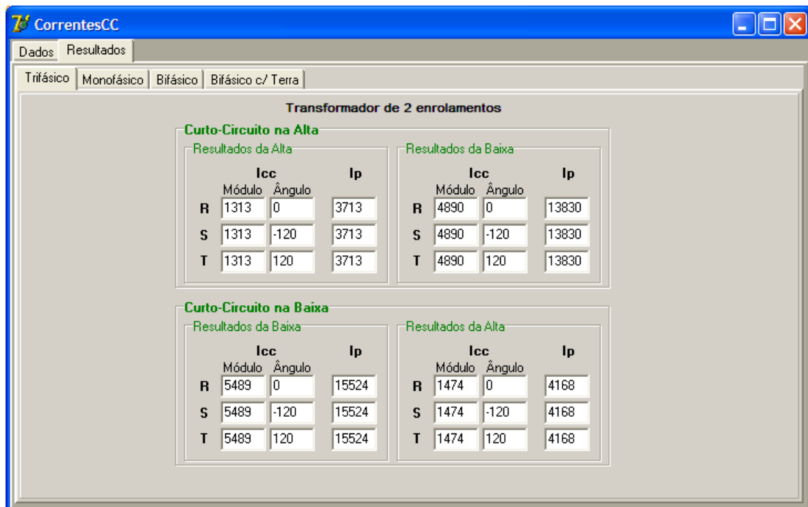
Figura 5.2 - Resultados dos Curto-circuitos trifásicos
