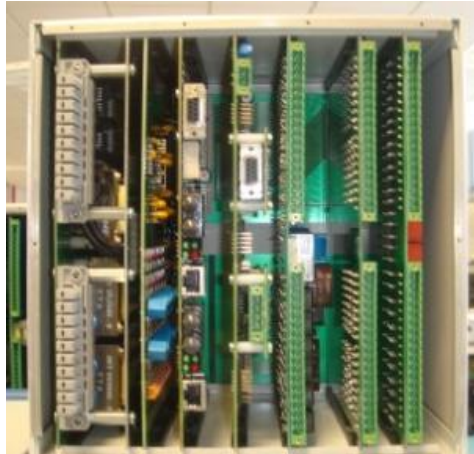
Figura 15 – X420 e as cartas electrónicas que este pode conter
