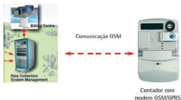
Figura 6.1.3 - Solução Iskra de Telecontagem [15]
