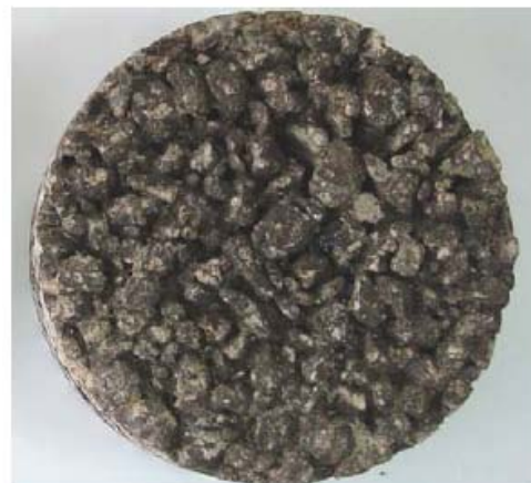
Fig. 6.5- Betão betuminoso drenante (Freitas et al. , 2008)
