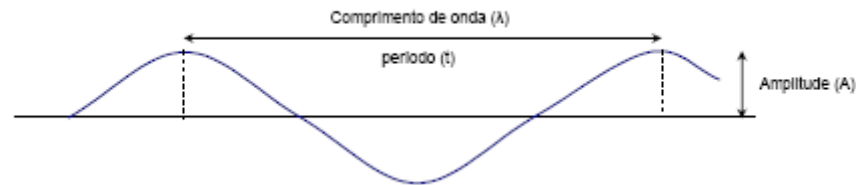
Fig. 2.1- Parâmetros físicos da onda sonora (Santos, 2007)
