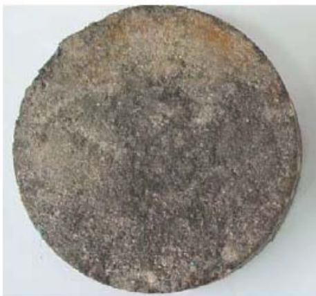
Fig. 6.4 - Betão betuminoso corrente (Freitas et al. , 2008)
