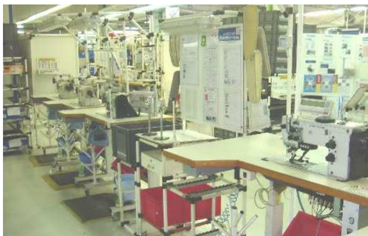
Figura 11 – Célula de costura “em linha” na Linha 6 (D2).
