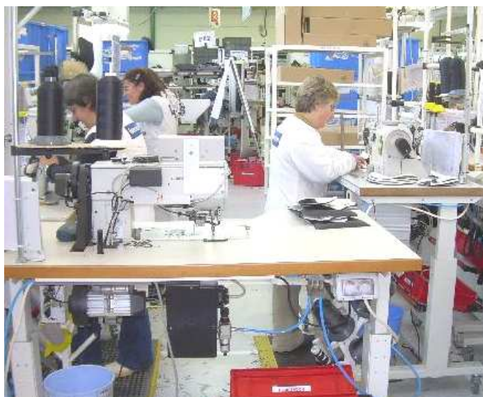
Figura 10 – Célula de costura “em U” da Linha 8 (X7).
