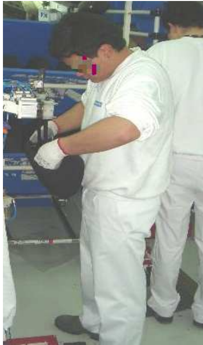
Figura 16 – Montagem da capa costurada no inserto metálico na linha 8.
