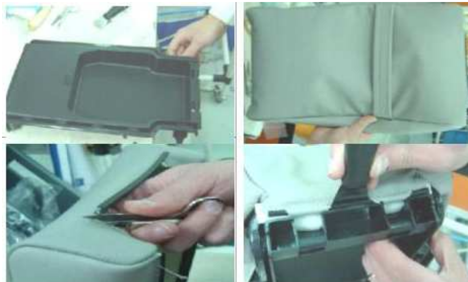
Figura 17 – Sequência de montagem da capa na caixa plástica do X7 APB.
