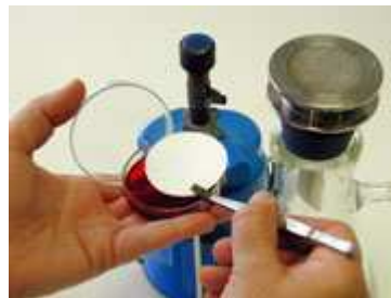
Figura 8 - Modo de incorporação da membrana filtrante na caixa de Petri que contém o meio sólido
