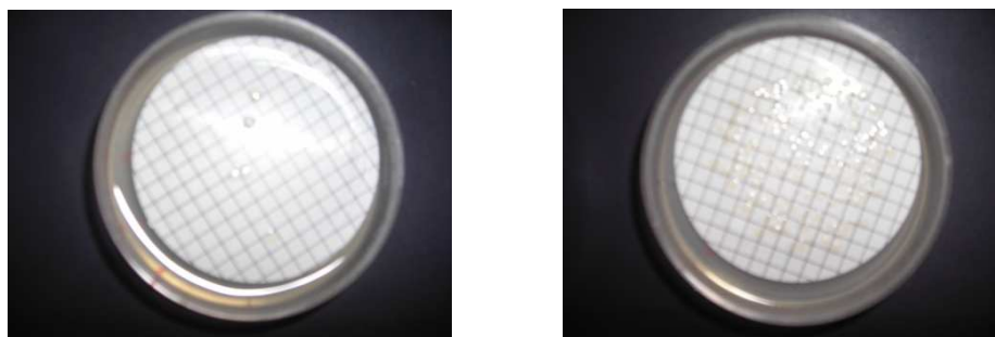
Figura 9 – Imagens de caixas de Petri que contém o meio sólido, com a membrana incorporada. À esquerda após 24 horas de incubação a T= 30\text{ }^{\circ}\text{C} e à direita após 48 horas de incubação a T= 30\text{ }^{\circ}\text{C}
