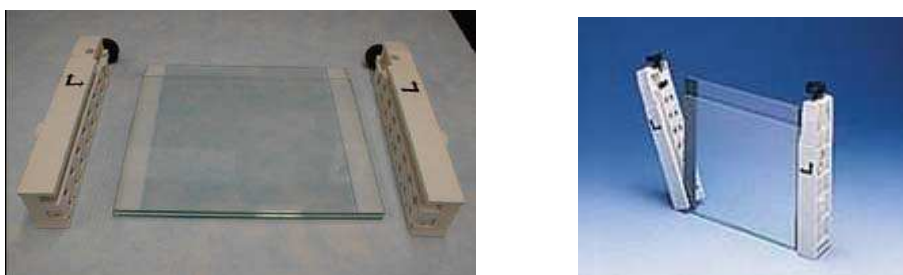
Figura 17 - Componentes da técnica de DGGE, dois adaptadores e dois espaçadores entre as duas placas de vidro
