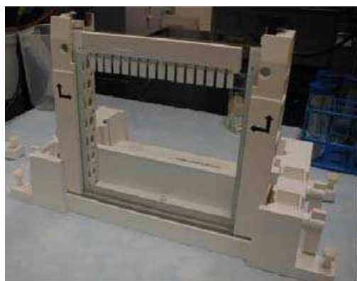
Figura 20 - Câmara de gel com o pente inserido
