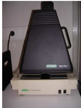
Figura 14 - Imagem do transiluminador usado na visualização das bandas desenvolvidas no gel
