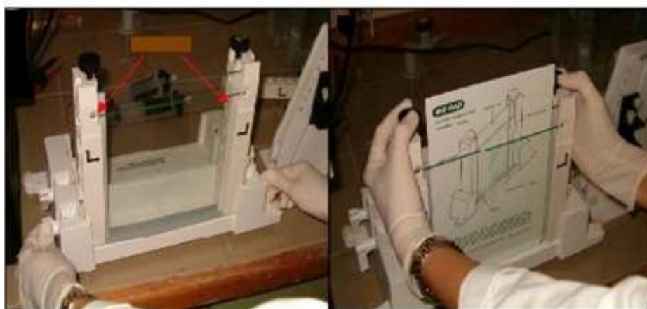
Figura 18 - Visualização da câmara de gel com as placas de vidro. À esquerda, montagem das placas e espaçadores e encaixe no suporte e à direita, ajuste da pressão com o cartão de alinhamento
