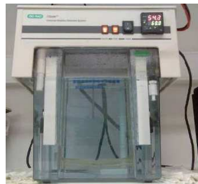
Figura 23 - Equipamento de DGGE, composto por uma tina de solução tampão de DGGE e o suporte core assembly
