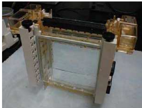
Figura 22 - Câmara de gel anexada ao core assembly
