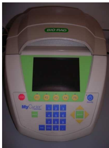
Figura 11 - Equipamento termociclador, responsável pela ocorrência dos vários ciclos e produtos de PCR
