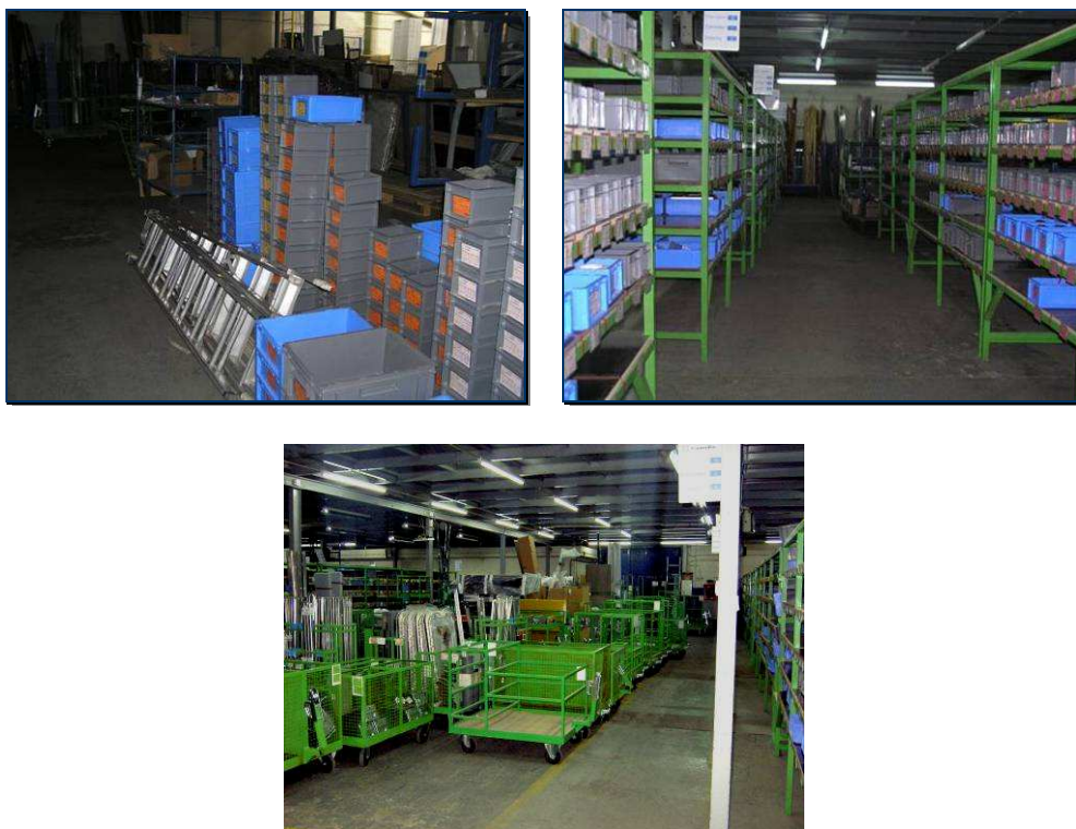
Figura 22 - Construção das áreas de "picking" dos supermercados (contentores e carros especiais)
