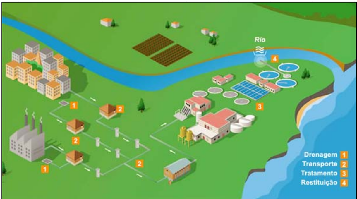
Figura 2.3 – Processo de rejeição ou devolução da água utilizada ao meio natural, (adapt. Consorcio de Aguas de Asturias, 2007)
