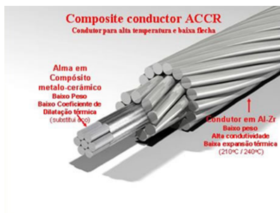
Figura 6.1: Composição do condutor ACCR
