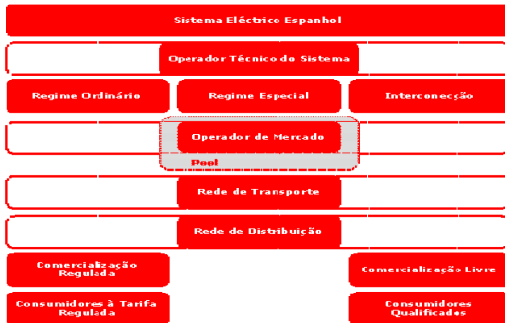
Figura 3.2 - Estrutura do Sector Eléctrico espanhol [11].
