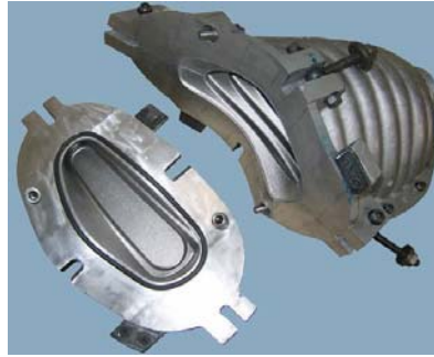
Figura A.30 - Molde em alumínio fundido
