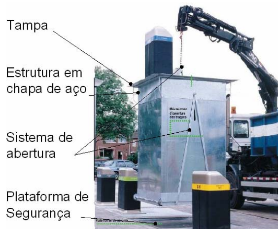
Figura 2.1.10 - Estrutura do contentor Cityspot da Plastic Omnium
