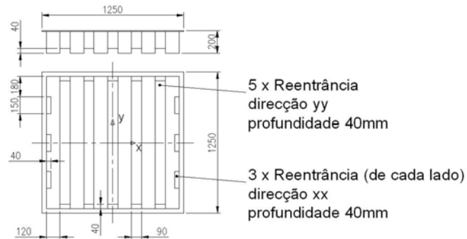
Figura B. 55 - Geometria final – Fundo Contentor Rotomoldado
