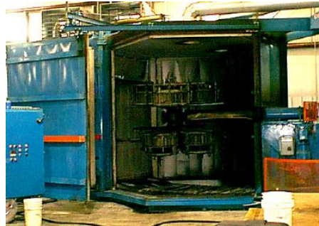
Figura A.2 - Aquecimento do molde em forno
