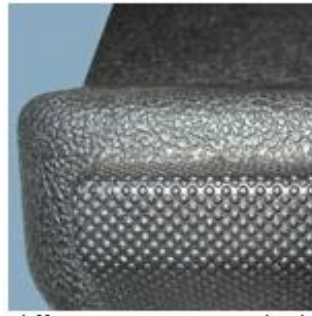
Figura A.6 - Textura metálica obtida por “photo etching”
