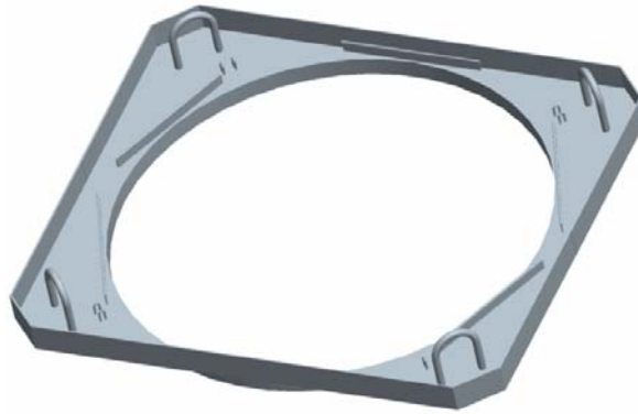
Figura 2.1.21 - Estrutura de suporte do aro da lona
