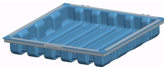
Figura 2.2.34 – Fundo com aro de reforço e olhais das dobradiças
