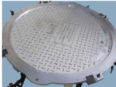
Figura A.31 - Molde em alumínio maquinado
