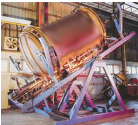
Figura A.35 - Máquinas com chama aberta - Conceito “Rock and Roll”
