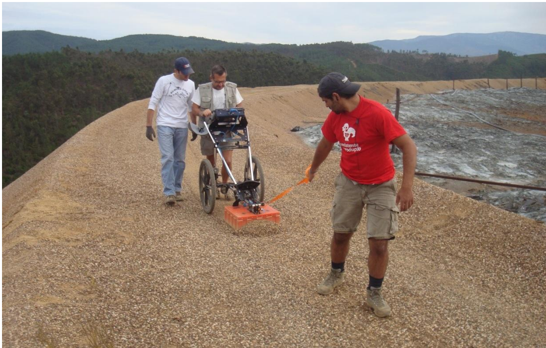
Figura 63 – Operação de amostragem de um perfil ao longo do coroamento.
