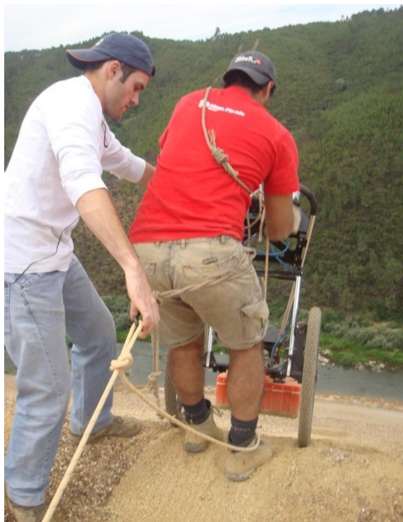
Figura 65- Preparação de um perfil do talude
