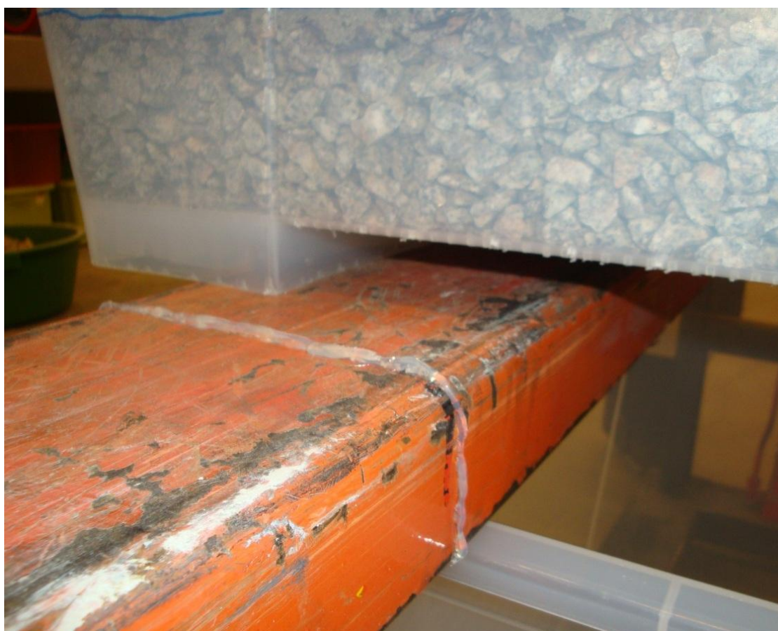
Figura 71 - Pormenor da vedação das pás do empilhador.
