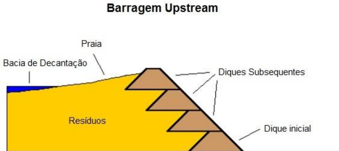
Figura 11 - Esquema da barragem Upstream (Fiúza 2009).
