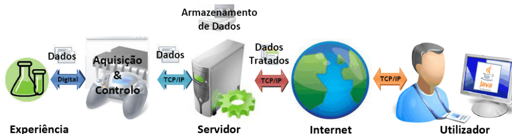
Figura 2.5 - Diagrama de blocos do sistema pretendido
