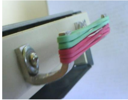
Figura 4.9 - Pormenor do sistema de amortecimento.
