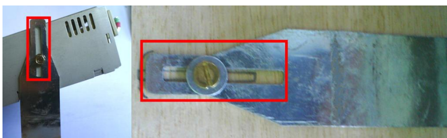
a) b) Figura 4.8 - Actuador para transporte do pêndulo para posição inicial: a) suporte e ajuste vertical, b) ajuste horizontal
