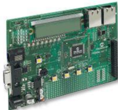
Figura 2.7 - PICDEM.net 2 , placa de desenvolvimento da Microchip
