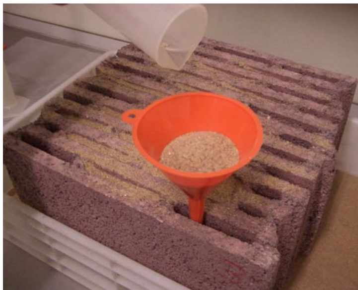
Figura 9 – Determinação da percentagem de furação de um bloco
