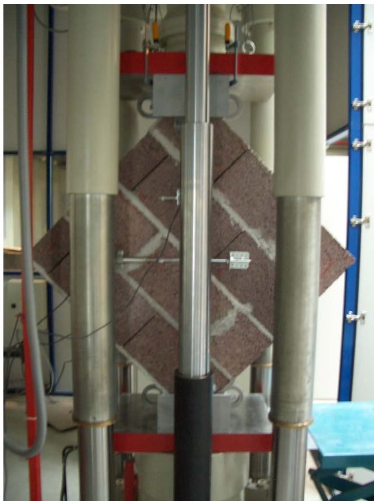
Figura 13 – Ensaio do provete à compressão diagonal
