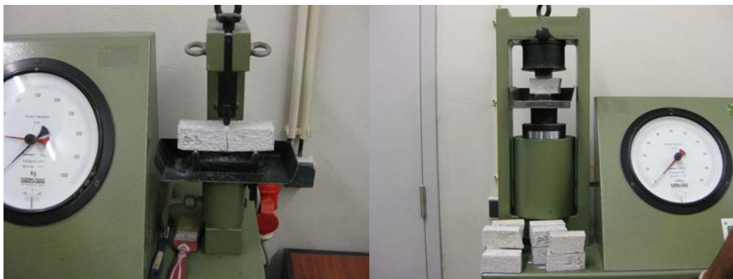
Figura 5 – Ensaio das argamassas à flexão (esq.) e compressão (dir.)
