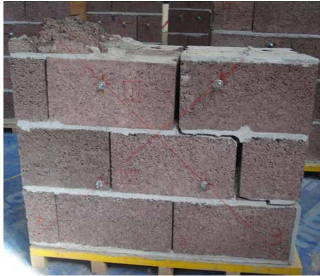
Figura 19 – Fendilhação do provete 3B
