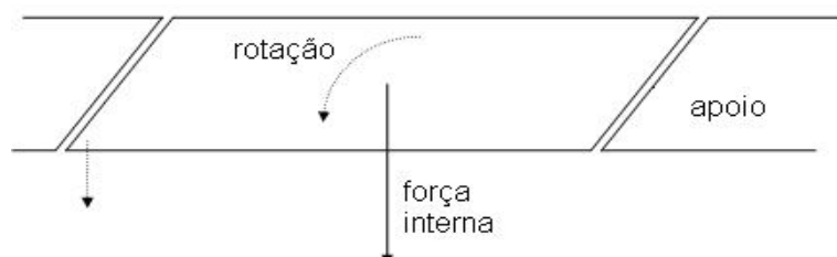
Fig. 2.1 – Esquema de rotação do tabuleiro sob acção sísmica
