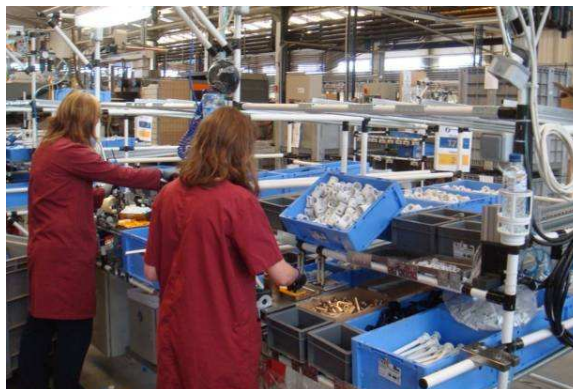
Figura 7- Célula de montagem com metodologias kaizen e 5S
