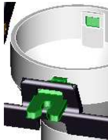
Figura 85- Interferência da geometria do gancho com o encaixe na alavanca
