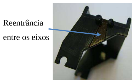
Figura 63- Alavanca superior alterada na zona dos eixos
