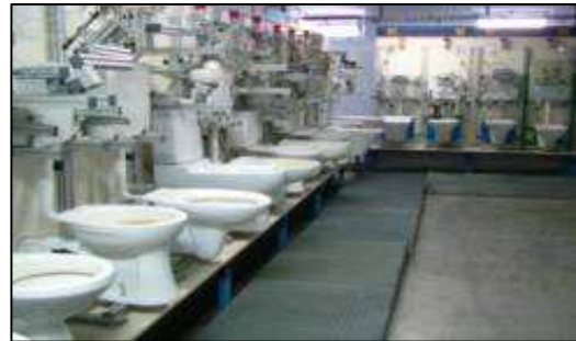
Figura 5- Laboratório de ensaio de testes de vida
