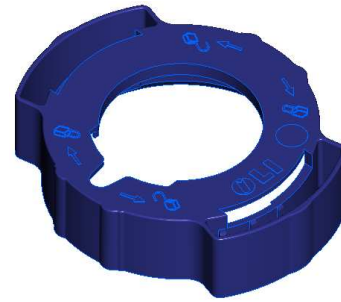
Figura 68- Tampão da iteração 4 com Ø41,5mm
