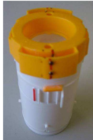
Figura 61- Protótipo do copo e do tampão feito a partir de peças injectadas
