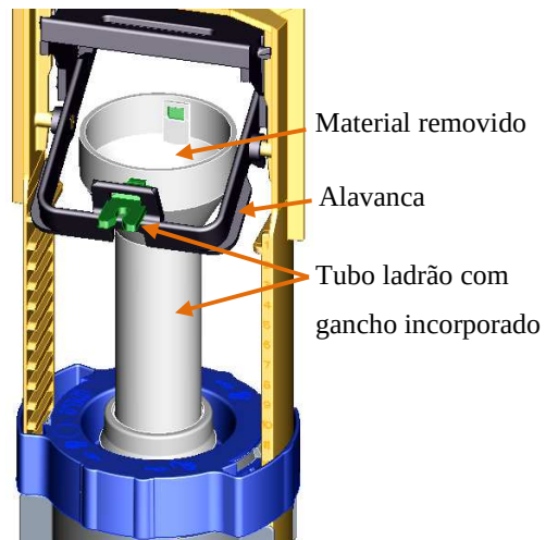
Figura 84- Mecanismo com tubo ladrão regulável com gancho incorporado (gancho original - 50915)
