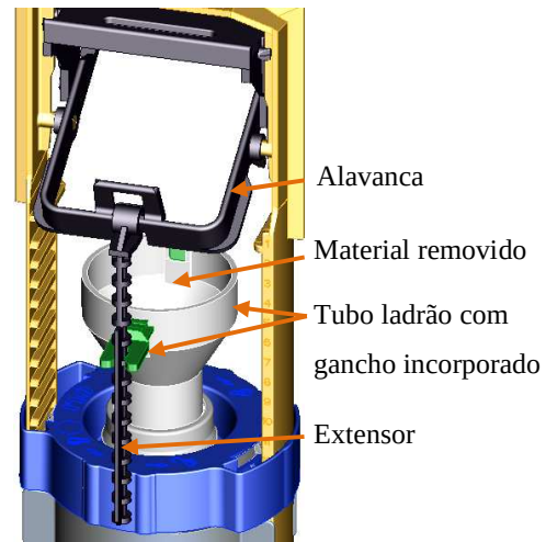
Figura 83- Mecanismo com tubo ladrão regulável com gancho incorporado (gancho original - 51041)
