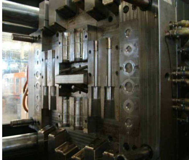
Figura 19- Vista do lado da injeção do molde-família “Poussoir”
