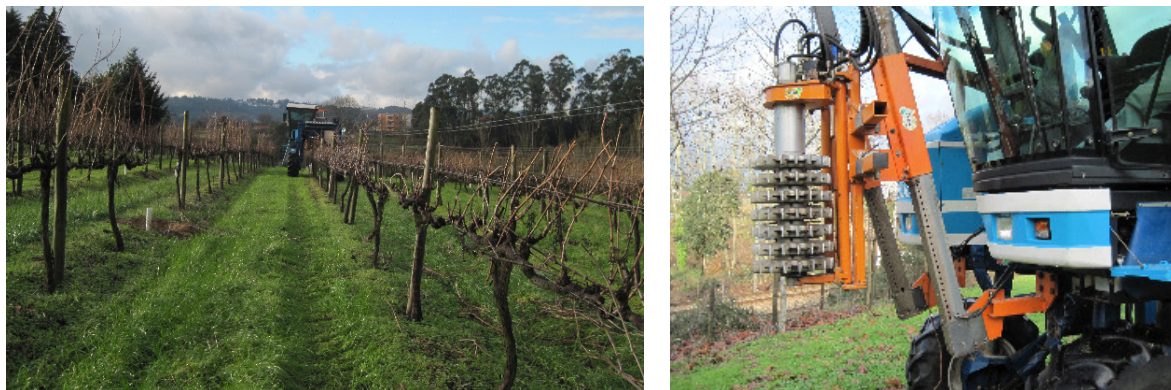
Figura 18. Operação de pré-poda mecânica realizada na Quinta da Aveleda (à esquerda) e dispositivo colocado na máquina de vindimar para a realização da pré-poda (à direita).
