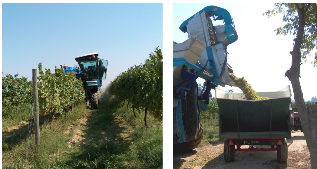
Figura 21. Vindima mecânica realizada na Quinta da Aveleda (à esquerda: colheita das uvas na vinha; à direita: passagem das uvas para os tractores para o transporte até ao centro de vinificação).
