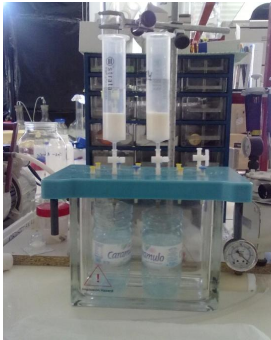
Figura 8. Instalação do Waters Sep-Pak Vacuum Manifold Millipore e das colunas Strata TM from phenomenex
