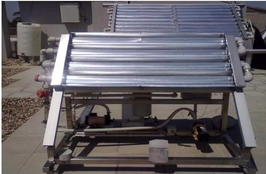
Figura 5. Instalação piloto com CPC's da FEUP
