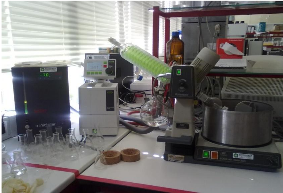
Figura 9. Fotografia do rotoevaporador BUCHI 461 Water Bath juntamente com a bomba de vácuo BUCHI Vacuum Pump V-700 e com o minichiller
