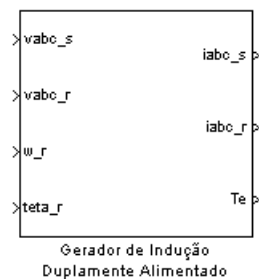
Figura 3.20: Bloco do Gerador de Indução Duplamente Alimentado.
