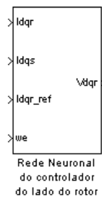
Figura 5.13: Rede neuronal do controlador do lado do rotor.
