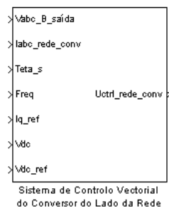
Figura 4.8: Bloco do sistema de controlo vectorial do conversor do lado da rede.
