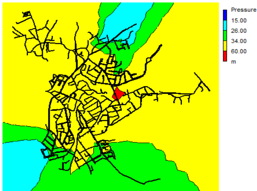
Figura 35 – Distribuição espacial das pressões às 05 horas (com PRV)
