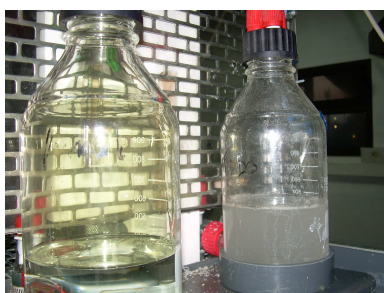
Figura 10 - Colectores das correntes que saiem da célula electroquímica
