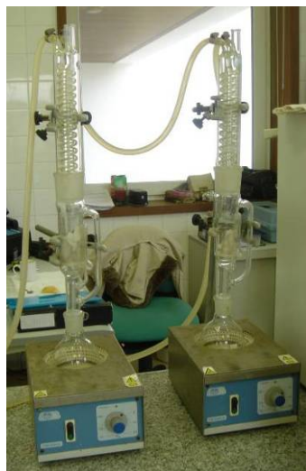
Figura 36 - Método de Extração por coluna de Soxhlet de óleos e gorduras, existentes nas amostras em estudo.
