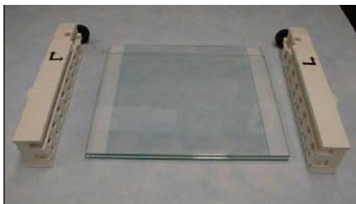
Figura 50 - Componentes da técnica de DGGE, tais como, dois adaptadores e dois espaçadores situados entre duas placas de vidro.
