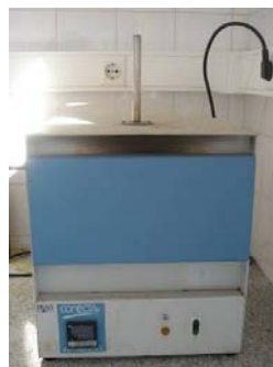
Figura 34 - Mufla, responsável pela calcinação dos resíduos persistentes no filtro, após secagem na estufa.
