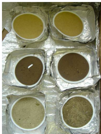
Figura 42 - Quantificação dos Sólidos Suspensos Totais presentes na amostra afluenta, lamas biológicas e efluente tratado, respectivamente, referentes ao dia 16 de Dezembro de 2007 (à esquerda) e ao dia 18 de Dezembro de 2007 (à direita).
