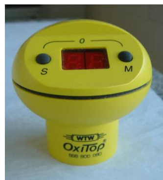
Figura 31 - Oxitop, equipamento registador e armazenador de valores de pressão gerados no headspace.
