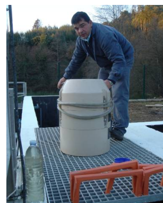
Figura 17 - Amostrador, utilizado na obtenção uma amostra final composta..
