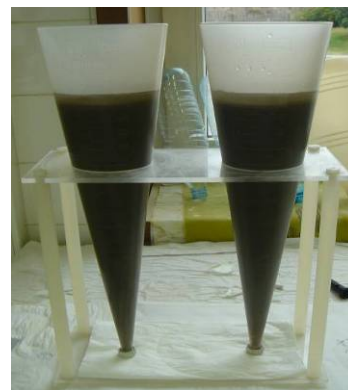
Figura 35 - Quantificação dos sólidos sedimentáveis, após sedimentação dos mesmos, em cones Imhoff.
