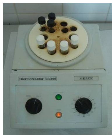
Figura 30 - Imagem representativa do termoreactor, responsável por promover as condições de temperatura, necessárias à reacção química.
