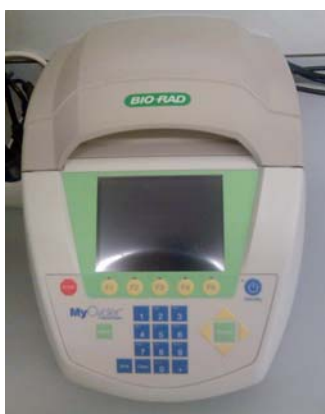
Figura 48 - Termociclador, responsável pela ocorrência dos vários ciclos de PCR.
