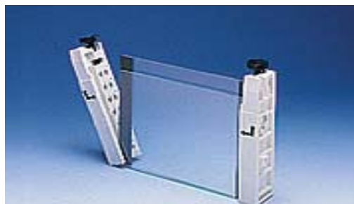
Figura 50 - Componentes da técnica de DGGE, tais como, dois adaptadores e dois espaçadores situados entre duas placas de vidro.
