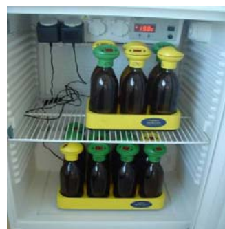
Figura 32 - Incubadora portadora de frascos de incubação, São igualmente visíveis os tabuleiros magnéticos.
