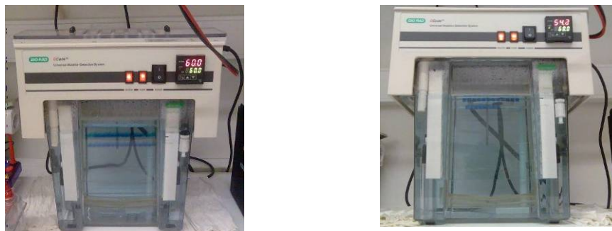
Figura 55 – Equipamento de DGGE, na sua plenitude, composto por uma Tina de electroforese preenchida com a solução tampão de corrida e o suporte core assembly .
