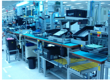
Figura 21: Postos de montagem final dos aparelhos
