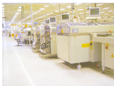
Figura 9: Parque de máquinas para a colocação de componentes eletrônicos
