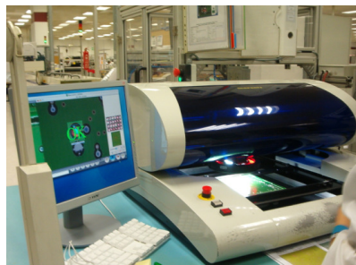
Figura 16: Equipamento de Inspeção da Face B
