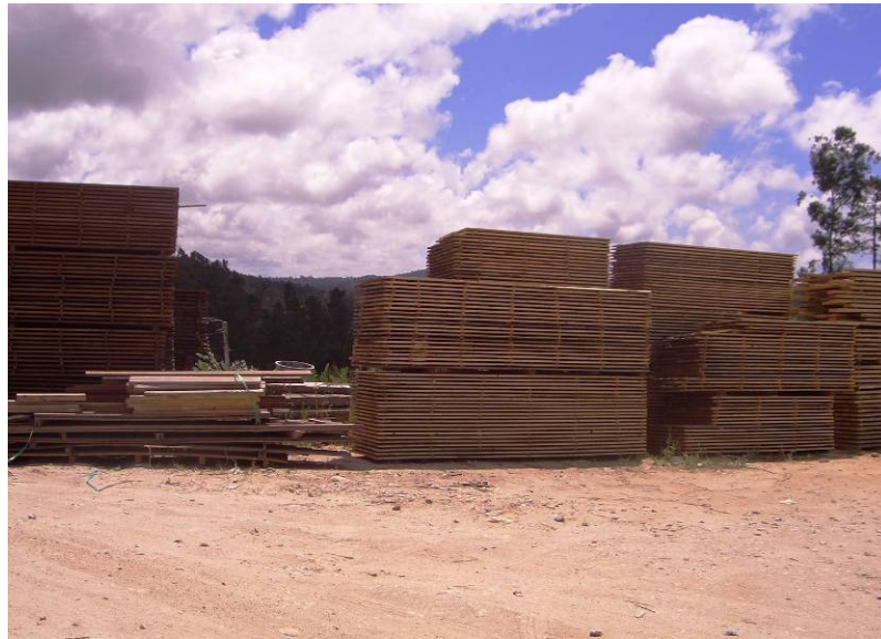
Fig. 3.5 – Pré-secagem no pátio exterior.
