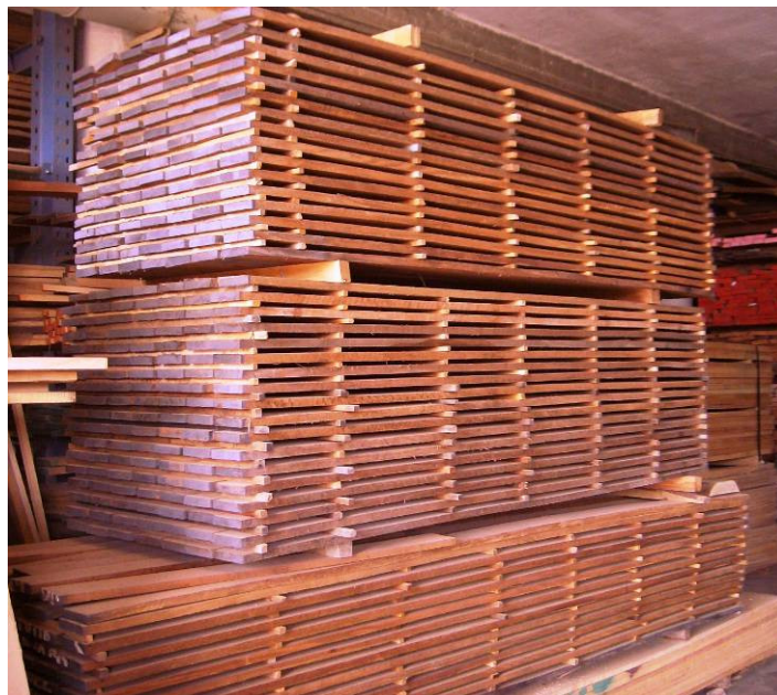
Fig. 3.6 – Pré-secagem no armazém coberto.
