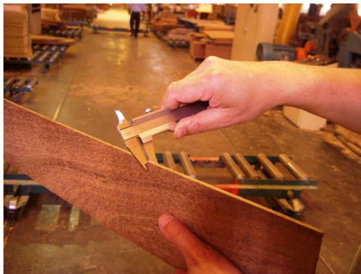
Fig. 3.10 – Verificação da espessura da camada nobre com um paquímetro.
