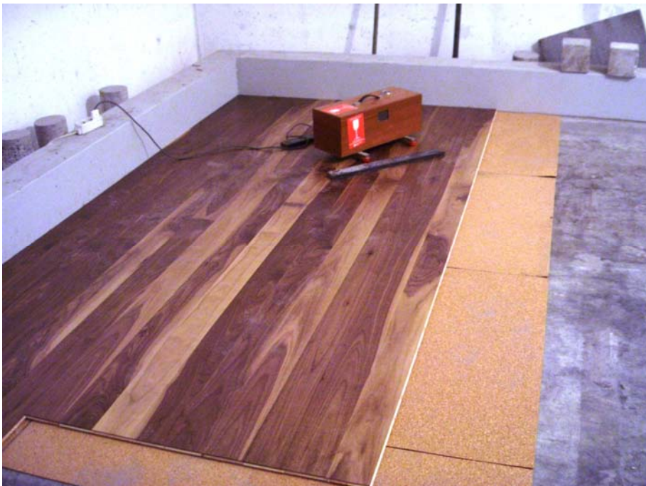
Fig. 5.14 – Ensaio sobre soalho de “Ingenious” Nogueira de 14 mm.
