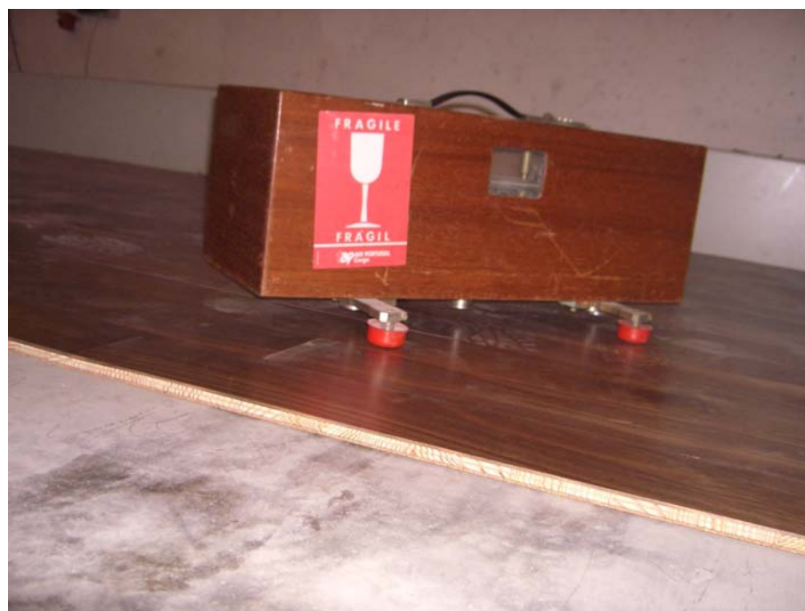
Fig. 5.12 – Máquina de percussão sobre amostra.
