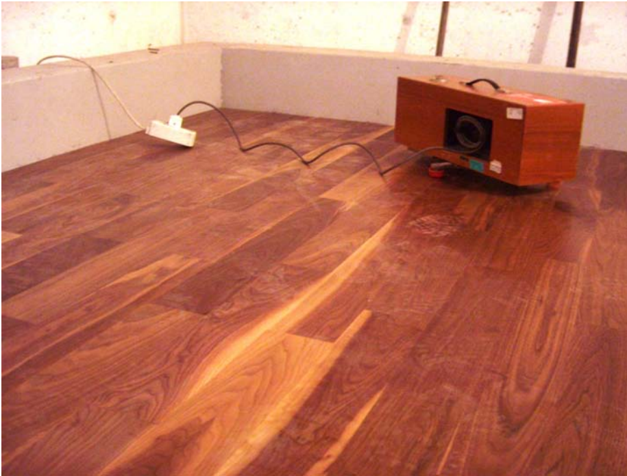
Fig. 5.13 – Máquina de percussão sobre amostra.
