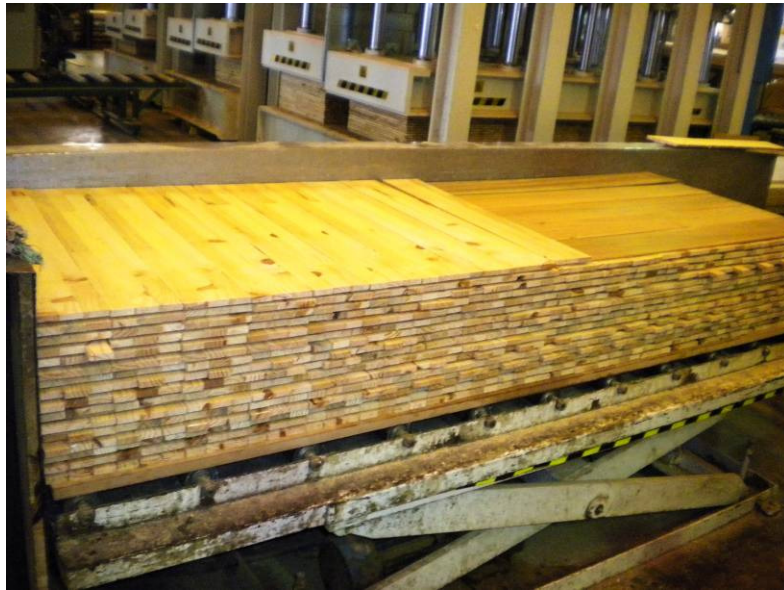
Fig. 3.12 – Colagem das camadas.
