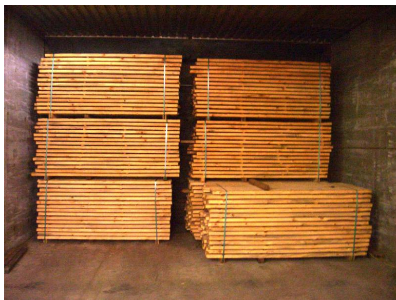
Fig. 3.8 – Madeira na estufa.
