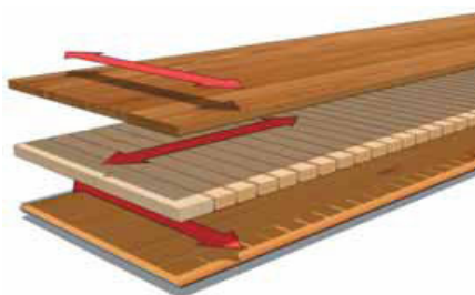
Fig. 2.9 – Direcção das camadas.
