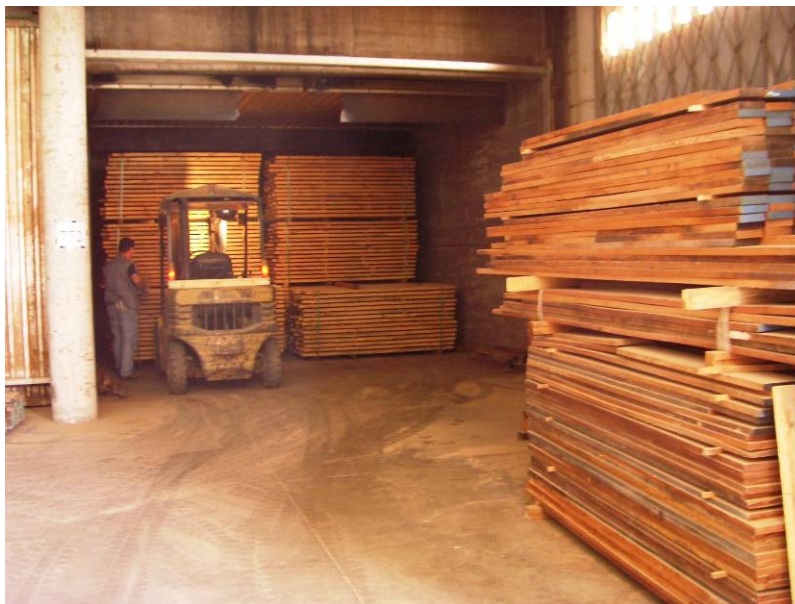
Fig. 3.7 – Secagem na estufa.
