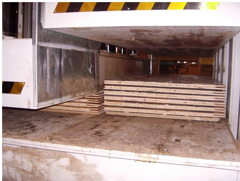
Fig. 3.13 – Prensa do painel final.
