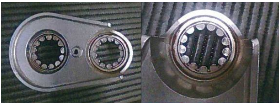
Figura 14: Porta rolamentos presente na caixa de velocidades.
