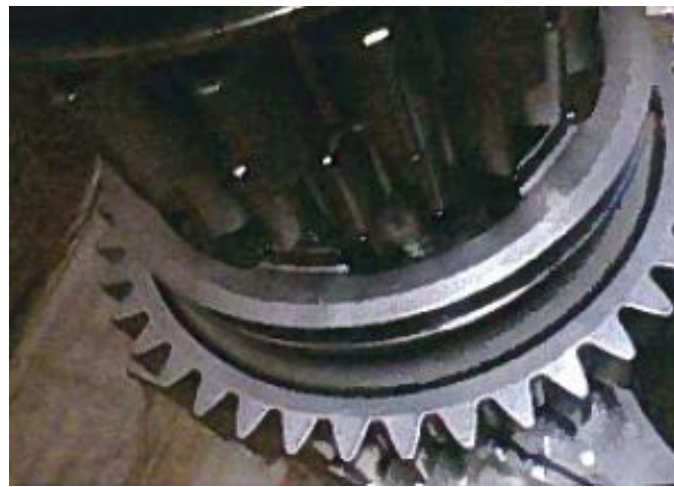
Figura 13: Anel de sincronização inserido no conjunto.
