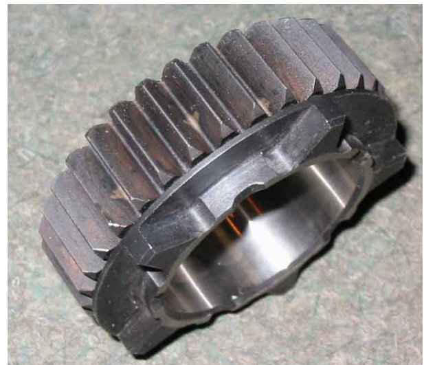
Figura 45: Exemplo de uma roda dentada com crabots .
