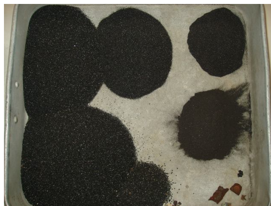
Figura 56. Fracções resultantes da análise granulométrica da gralha do segundo fornecimento.
