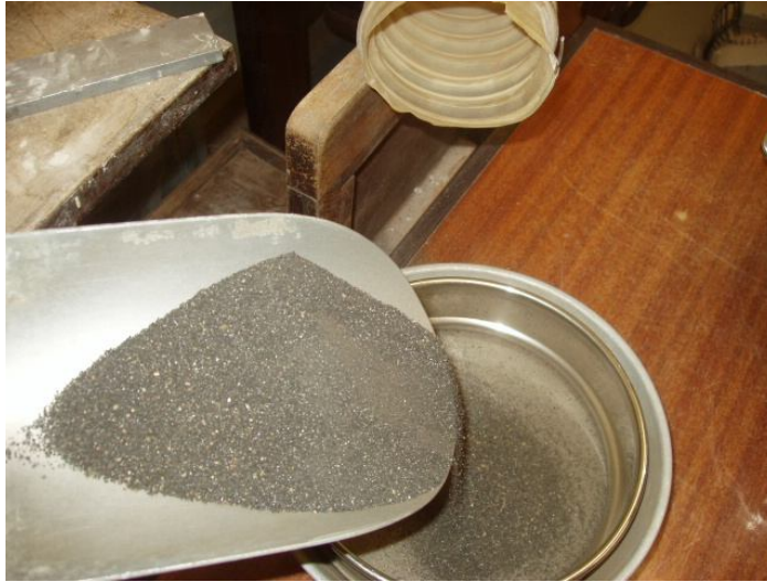
Figura 43. Peneiração manual da granalha para remoção dos finos com auxílio de um extractor de ar por ventilação forçada.
