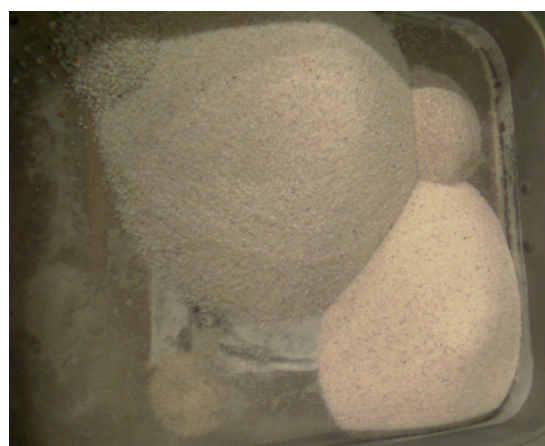
Figura 62. Fracções resultantes da análise granulométrica da areia fina natural.
