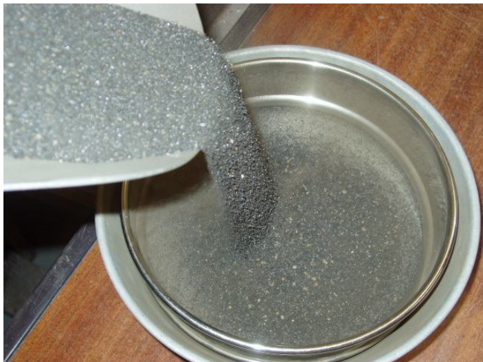
Figura 44. Imagem da libertação do pó de óxido de ferro durante a peneiração da granalha.
