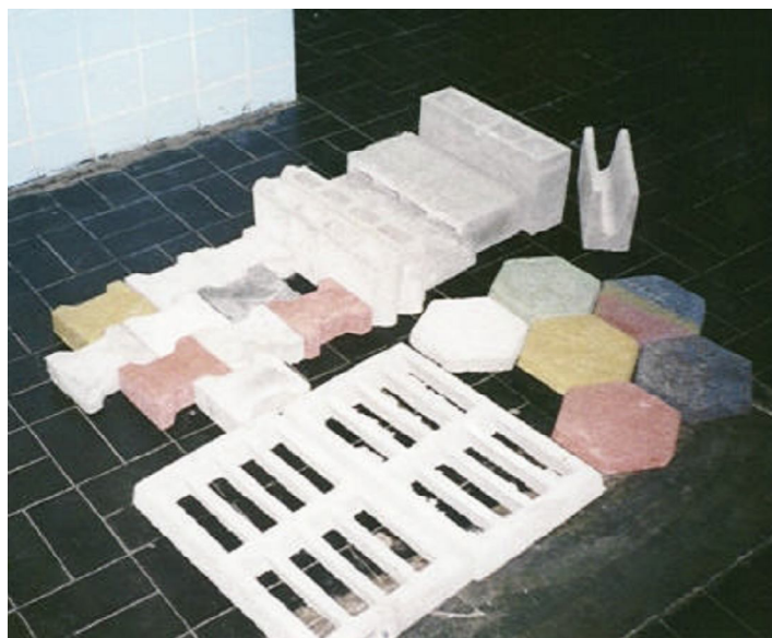
Figura 35. Elementos pré-fabricados com escória de cobre como agregado fino (Moura 2000).
