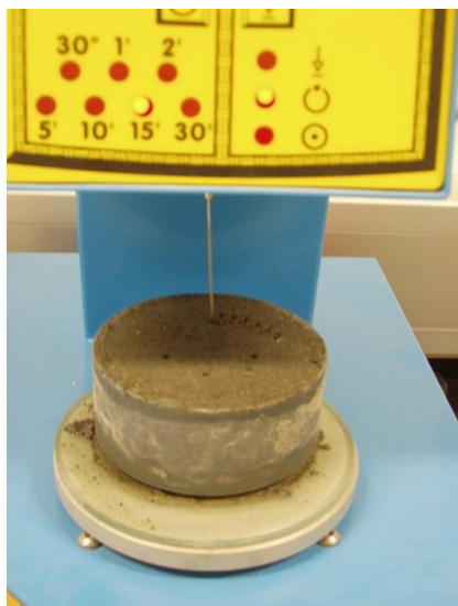
Figura 65. Ensaio dos tempos de presa com recurso a equipamento automático.
