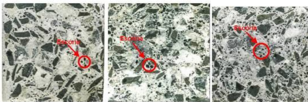
Figura 30. Aspecto das secções rompidas de provetes com 30, 40 e 50% de substituição de areia fina por escória de cobre, respectivamente (Moura 2000).
