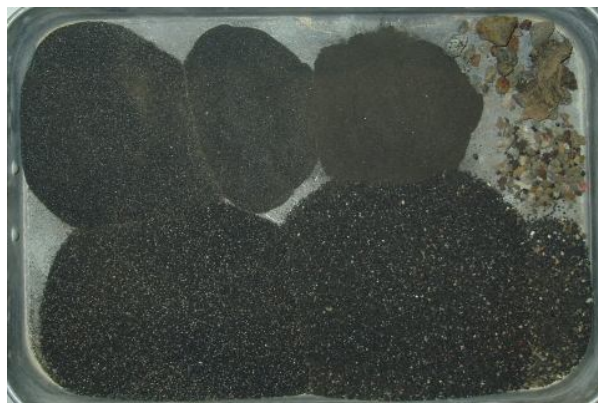
Figura 52. Frações resultantes da análise granulométrica da granalha do primeiro fornecimento.
