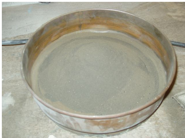
Figura 46. Material fino rejeitado da granulometria da granalha do primeiro fornecimento.
