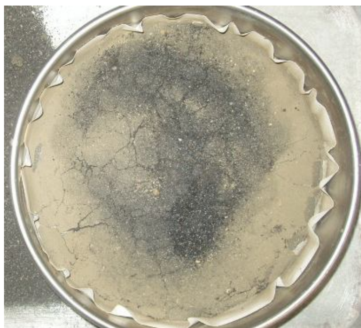
Figura 42. Peneiro e um dos filtros usados na lavagem da granalha do primeiro fornecimento, depois de seco em estufa.
