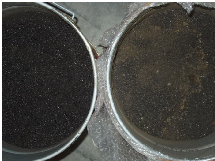
Figura 47. Aspecto da granalha do segundo fornecimento (à esquerda) e do segundo fornecimento (à direita).
