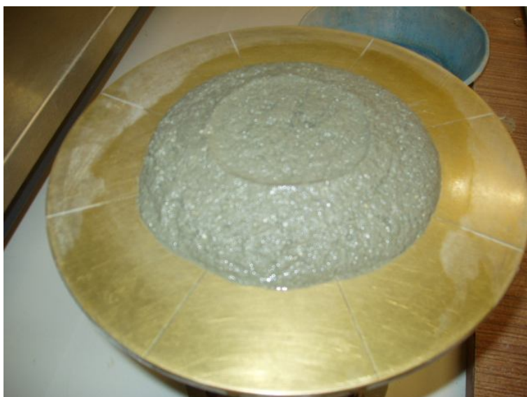
Figura 64. Ensaio do espalhamento de argamassas.
