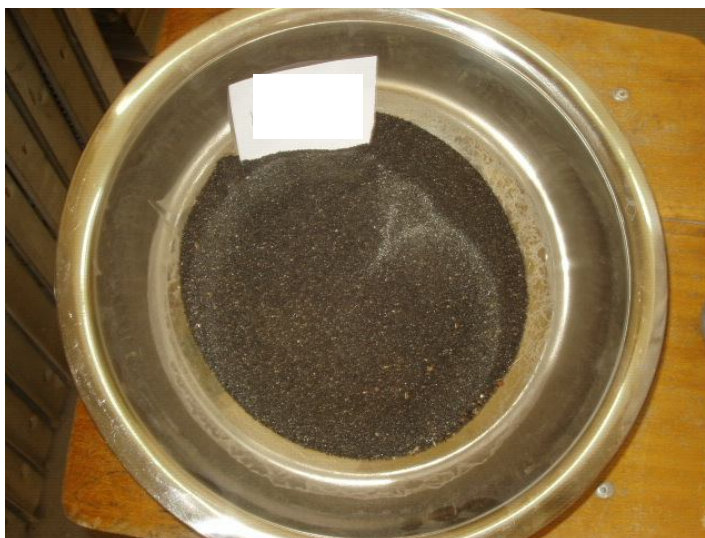
Figura 40. Aspecto da granalha do primeiro fornecimento, lavada e seca.
