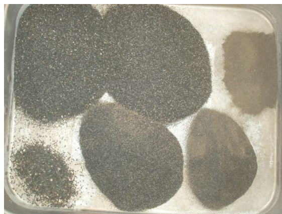
Figura 53. Frações resultantes da análise granulométrica da granalha do primeiro fornecimento, lavada.
