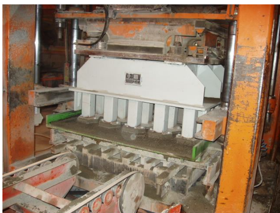
Figura 116. Fabrico de pavês: moldagem a alta vibração.
