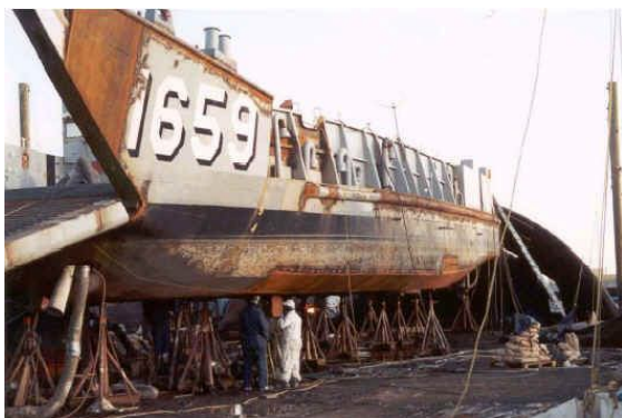
Figura 8. Decapagem de superfícies metálicas [8].
