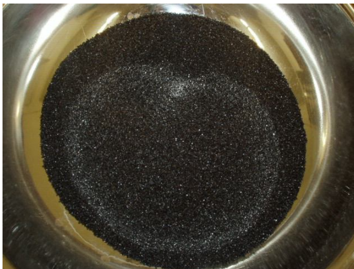
Figura 48. Escória de cobre original.
