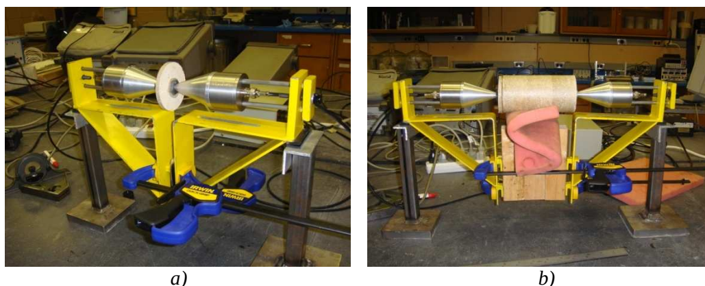
Figura 43.1 – Sistema adoptado para o cálculo da FRF_S pelo terceiro método: a) FRF_{TR} ; b) FRF_{TSR}
