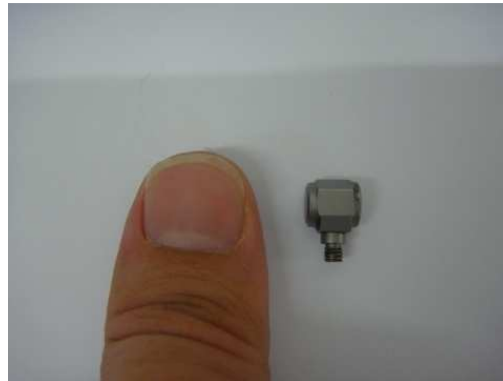
Figura 32.5 – Acelerómetro utilizado nos ensaios para determinação do tempo de propagação das ondas longitudinais no Laboratório de Geotecnia da FEUP
