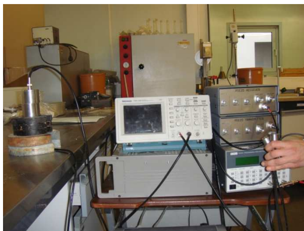
Figura 1 – Transdutores ultra-sónicos, osciloscópio, transdutores piezo-eléctricos, piezo-receptor, piezo-transmissor e gerador de funções
