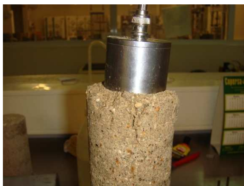
Figura 42.1 – Provet destruído por excesso de tensão de compressão induzida no ensaio
