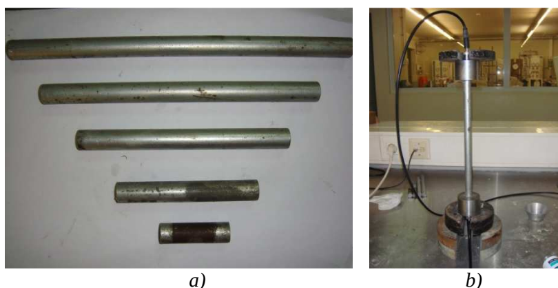
Figura 32.11 – Provetes de aço: a) representação dos diferentes tamanhos; b) sistema adoptado para a realização desta calibração
