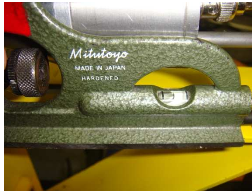
Figura 33.7 – Posição do nível para uniformização da pressão aplicada a todos os provetes
