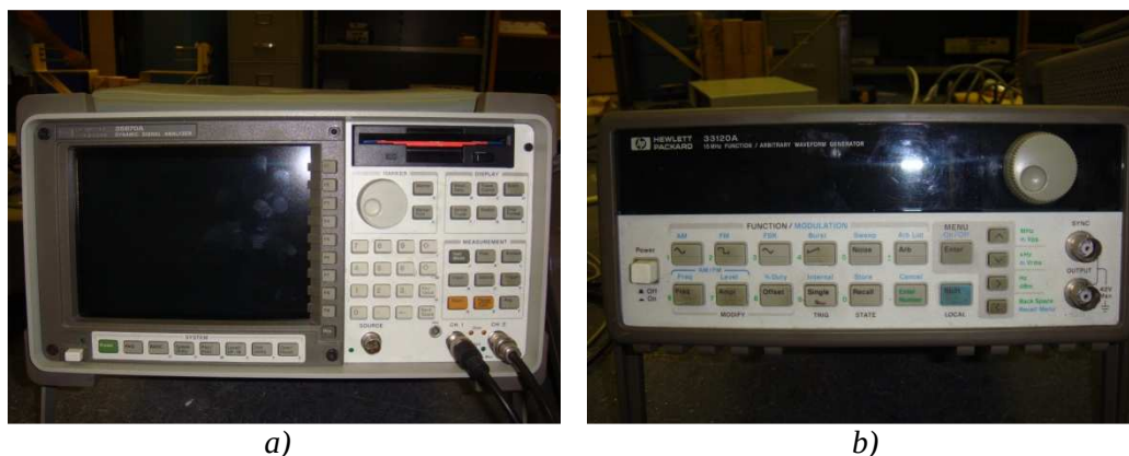
Figura 33.2 – Geradores de funções utilizados na UoW: a) 36670A DYNAMIC SIGNAL ANALYZER ®; b) 22120A 15 MHz FUNCTION/ARBITRARY WAVEFORM GENERATOR ®
