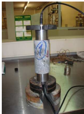
Figura 32.9 – Disposição adoptada para leitura das ondas longitudinais
