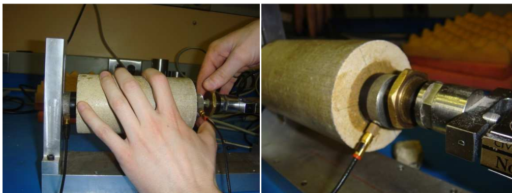
Figura 33.33 – Sistema adoptado para a caracterização das ondas de compressão
