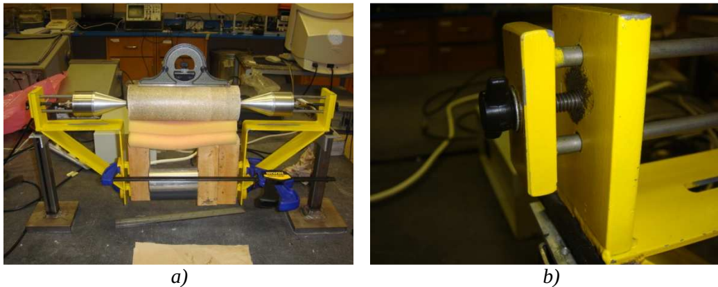
Figura 33.5 – Sistema de suporte dos provetes para os ensaios realizados na UoW: a) Estrutura de suporte; b) Mecanismo de regularização da tensão aplicada ao provete
