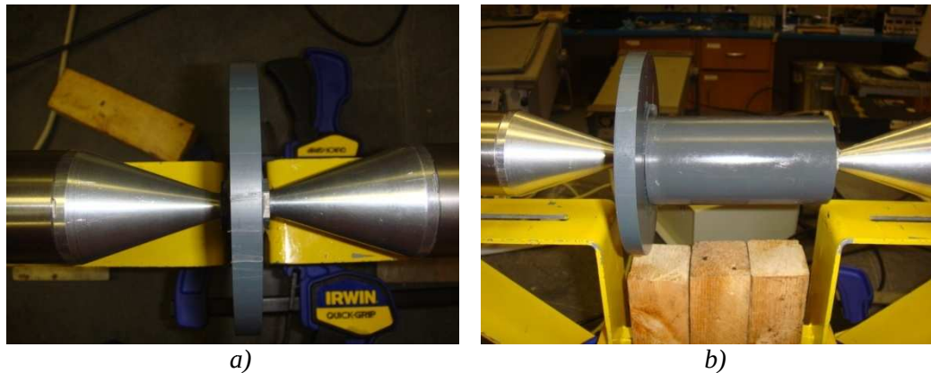
Figura 33.27 – Sistemas implementados para análise do provete utilizando o terceiro método: a) Transdutores em contacto, FRF_{TR} ; b) Provete entre os transdutores, FRF_{TSR}
