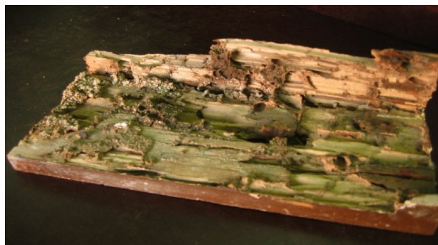
Fig.2.3 – Madeira atacada por térmitas [12]
