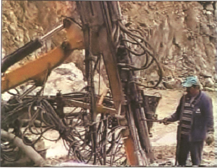
Foto 8- Operador de carro de perfuração a executar a lubrificação para o acoplamento de vara.
