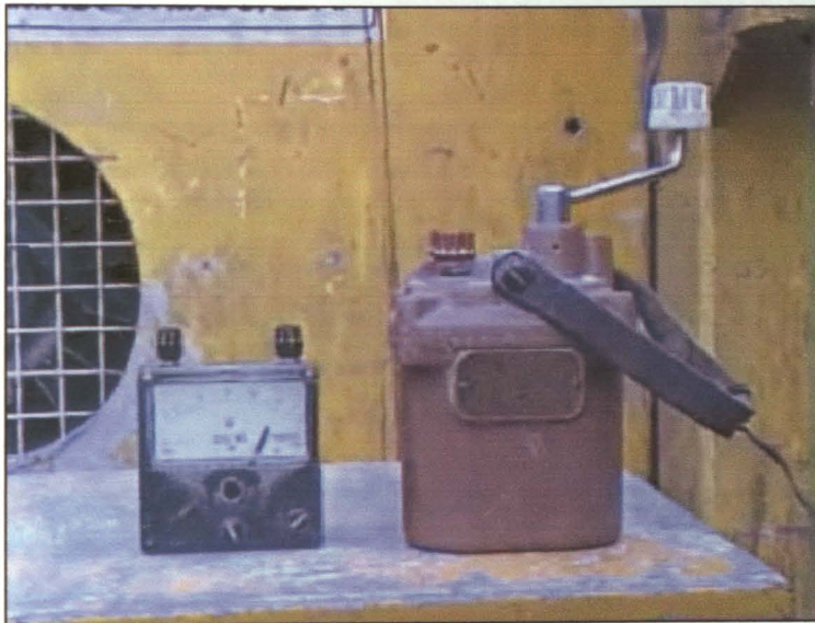
Foto 17- Ohmímetro (esquerda) e explosor (direita).
