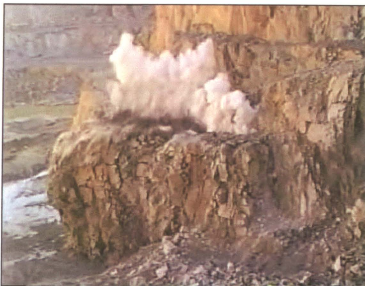
Foto 1- Detonação de uma pega de fogo na pedreira da Malaposta
