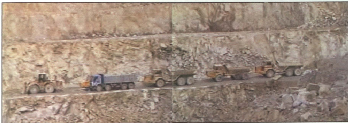
Foto 19- Panorâmica das máquinas em espera para a detonação de uma frente na pedreira da Malaposta.
