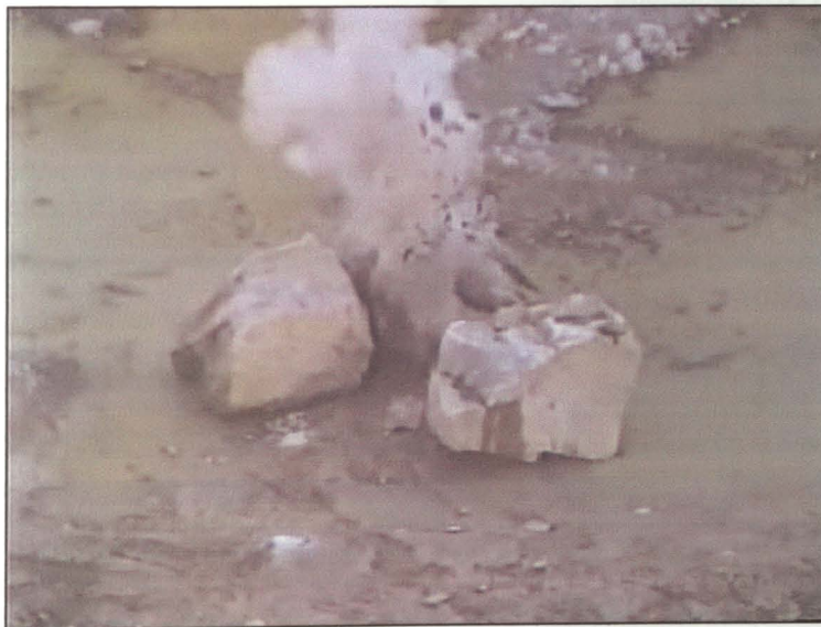
Foto 15- Rebentamento secundário realizado na pedreira da Malaposta.
