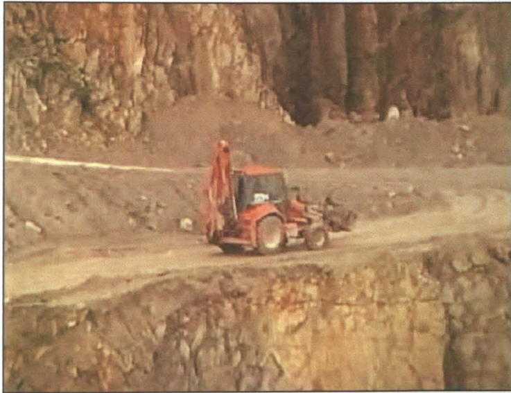
Foto 12- Pá-carregadora de pequenas dimensões utilizada para o transporte de explosivos e pó de pedra.
