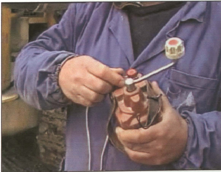
Foto 16- Procedimento de ligação da extensão eléctrica aos bornes do explosor.
