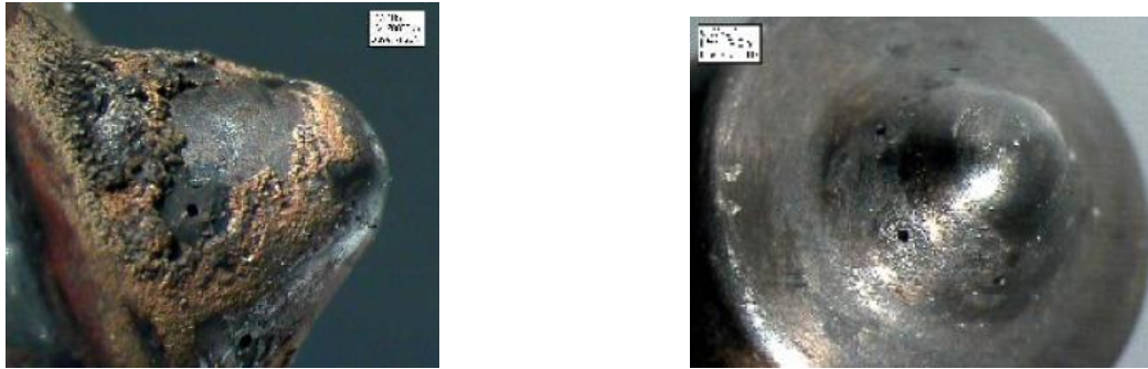
Figura 46: a-b) coqueamento do bico causado por Biodiesel; c-d) coqueamento do bico causado pelo gasóleo [Leandro H. Benvenuti – Ford Motor Company – Combustíveis e Lubrificantes]
