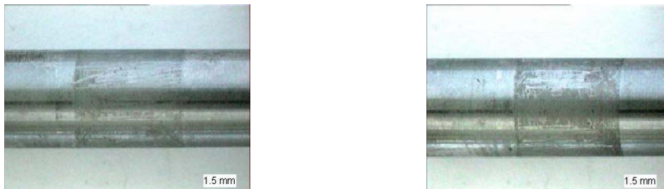
Figura 43: a e b – Veio de accionamento de bomba rotativa de alta pressão com desgaste [Leandro H. Benvenuti – Ford Motor Company – Combustíveis e Lubrificantes]
