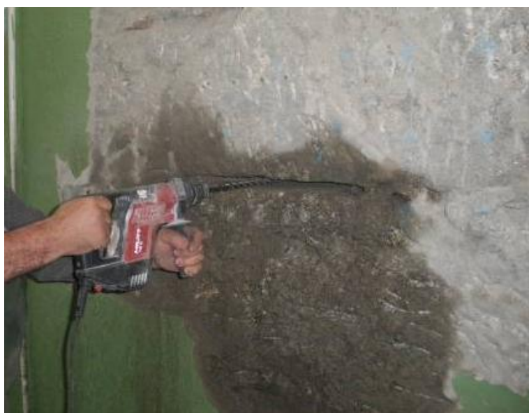
Fig.3.1 – Parede testada com a técnica de macacos planos [1]
