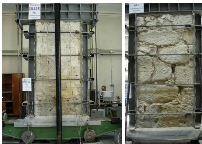
Fig.5.10. – Parede de Alvenaria de Pedra PP2 [6]
